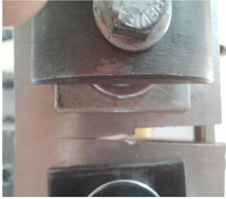
*Figure 3.7 : Trajet de fissuration pour un mode I pur*
