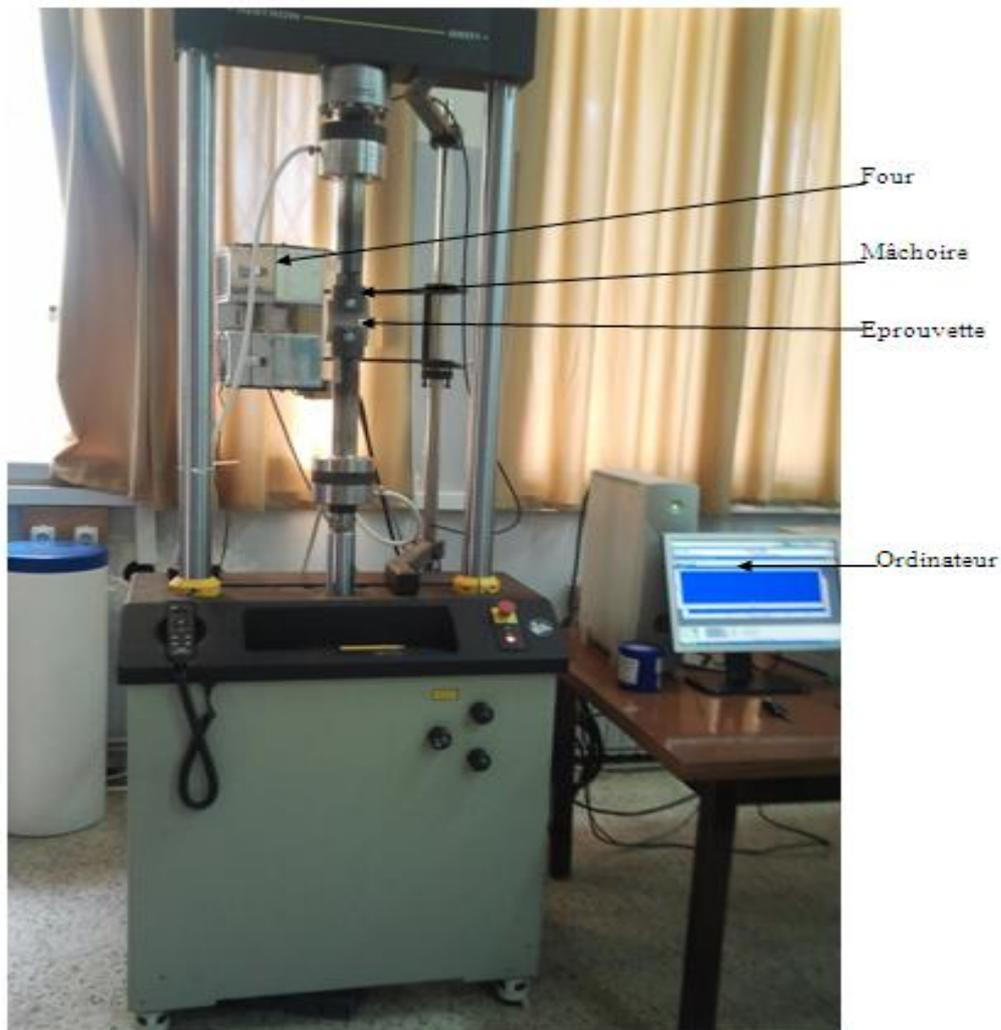
*Figure 3.1 : Machine d'essai de fatigue INSTRON*
