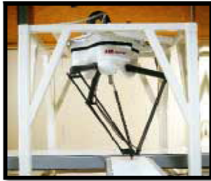
Figure I- 6 : ABB FlexPicker - Robot Delta avec rotation de l'organe terminal.
