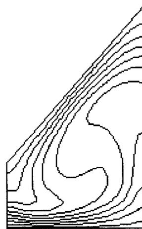
fig 6.7: Influence de l'angle d'inclinaison de la paroi supérieure; ( $Ra = 5 \cdot 10^4$ ,  $Rf = 1$ )
