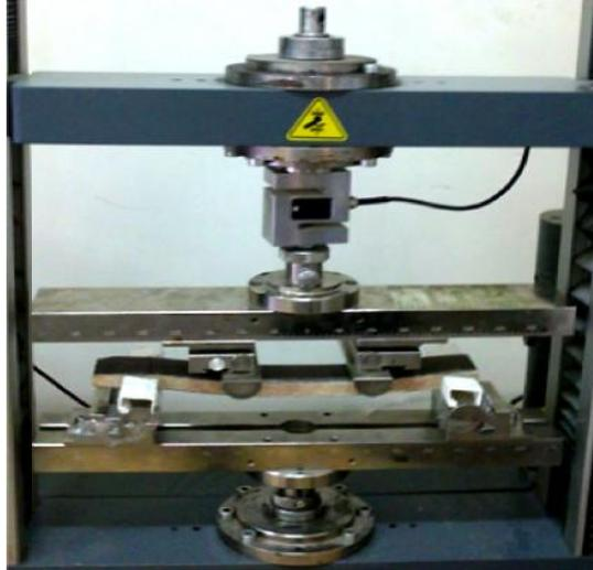
Figure 3.22 : Essai de flexion quatre points.
