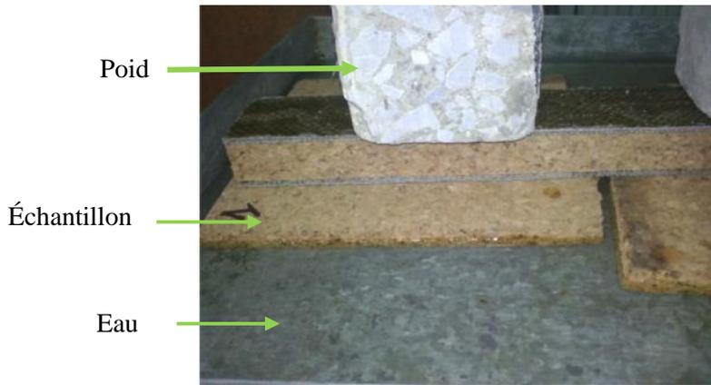
**Figure 2.17** : Immersion partielle du liège.
