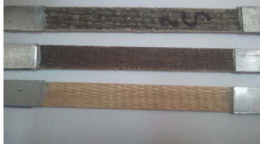
Figure 3.18 : échantillon des éprouvettes coupées et étalonnées
