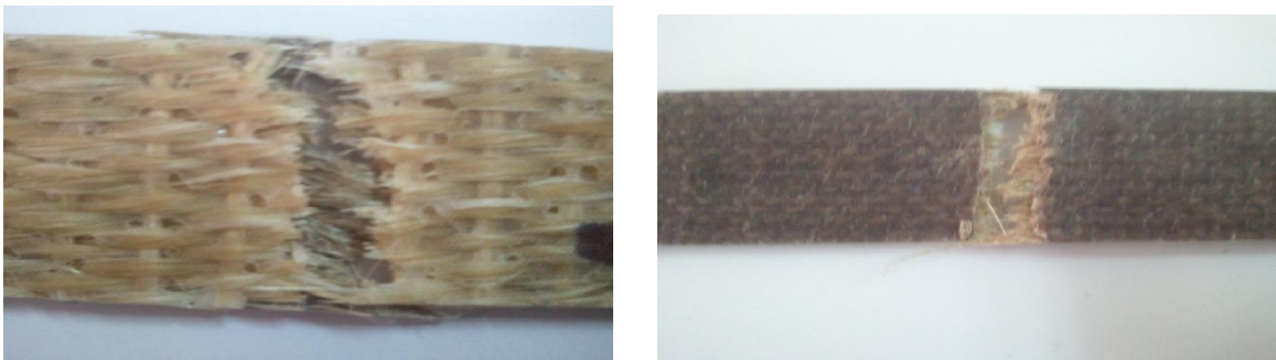
Figure.3. 21: mode de rupture de stratifié jute lin sisal et le stratifié jute
