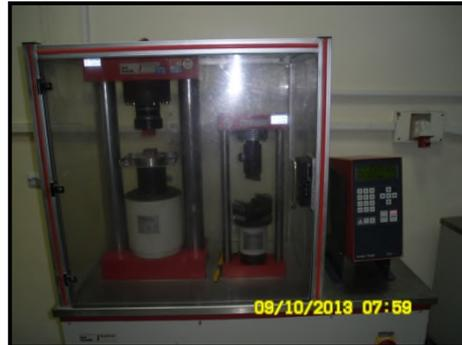
**Figure VI.35:** Appareil de flexion-compression.
