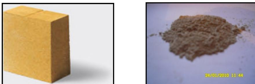
**Figure IV.25:** Déchet de brique réfractaire HTA avant et après utilisation.
