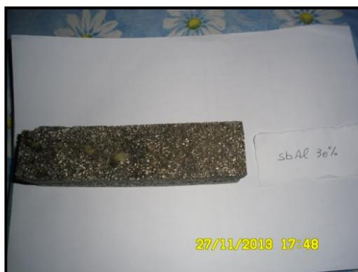
**Figure VI.46:** Eprouvette SbAl30% ayant subi un traitement thermique à 1400°C.
