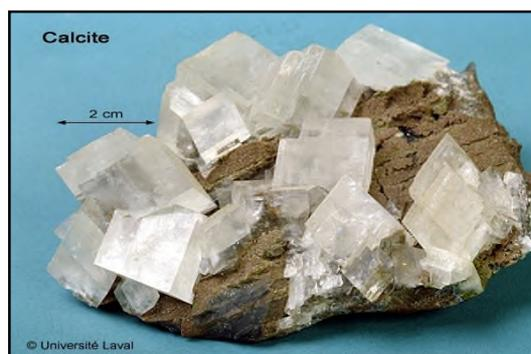
**Figure II.10:** Une calcite dans le système rhomboédrique.
