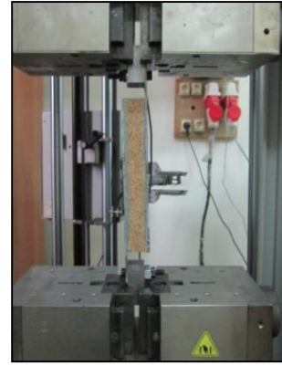
Figure V.9. Banc d'essai utilisé dans les essais expérimentaux de cisaillement (SB40) [136].
