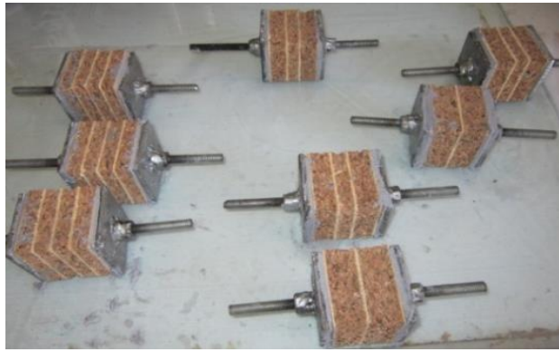
Figure V.7. Éprouvettes de l'essai de traction selon la norme (NF T 54-603).
