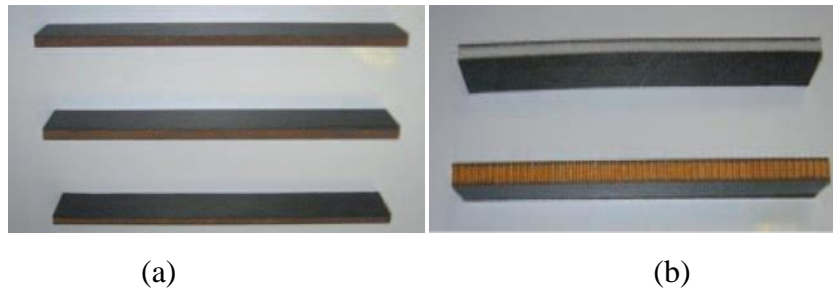
Figure III.8. Échantillons sandwichs avec des noyaux de : (a) agglomérés de liège et (b) Rohacell et la CEA en nid d'abeille.
