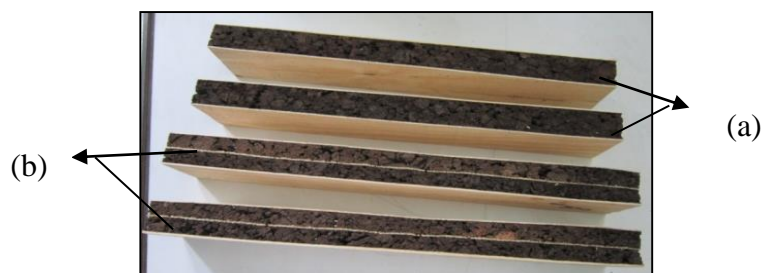
Figure V.17. Configurations des panneaux sandwichs à base de liège expansé :
