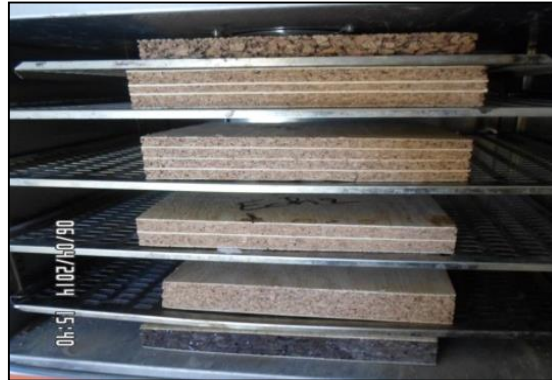
Figure V.11. Échantillons des panneaux sandwiches portés à 100°C pendant 24 heures.
