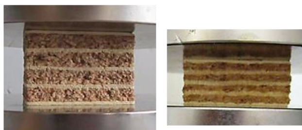
Figure V.34. Image du liège s'agglomère dans le panneau sandwich S20 avant (à gauche) et après (à droite) compression dans la direction perpendiculaire.
