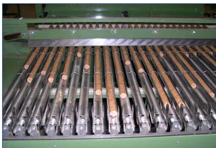
Figure III.1. Bâton de liège aggloméré pour la production des bouchons [85].
