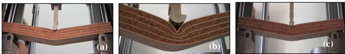
Figure V.43. Séquence de la défaillance des échantillons à base de liège (SB10) ; en flexion 3 points, (a) début du test, (b) compression maximale et (c) retour à l'état initial.
