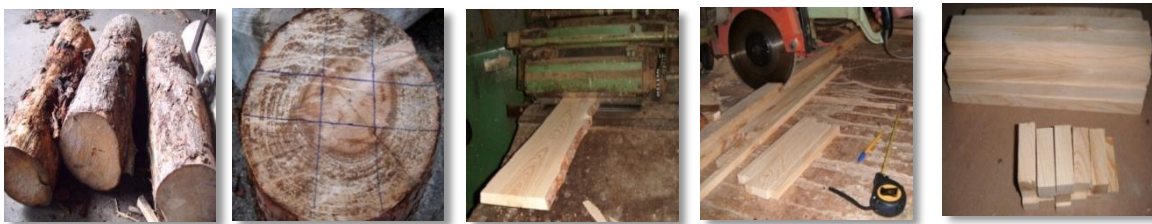
Figure IV.1. Étapes de préparation des éprouvettes (coupe et rabotage), pour la caractérisation physico-mécanique.
