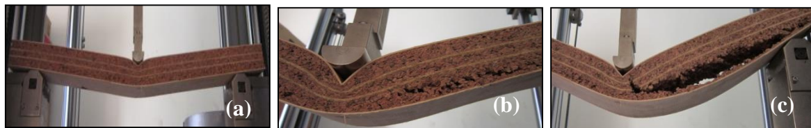
Figure V.42. Progression des fissures (SB15) en flexion 3 points : (a) début du test, (b) apparition et propagation de la fissure, (c) limite de propagation de la fissure à l'extrémité de l'échantillon [136].
