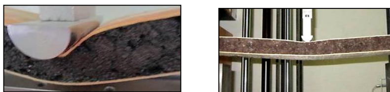
Figure V.27. Panneau sandwich SN40 sous la compression maximale en flexion 3 points (à gauche) et récupération après l'élimination de contraintes (à droite).
