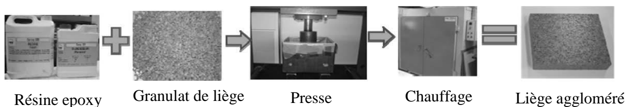
Figure III.2. Schéma du procédé de fabrication utilisé pour obtenir les agglomérats de liège époxy.
