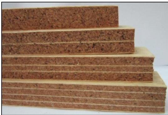
Figure V.31. Structures sandwiches multicouches à base de liège aggloméré.
