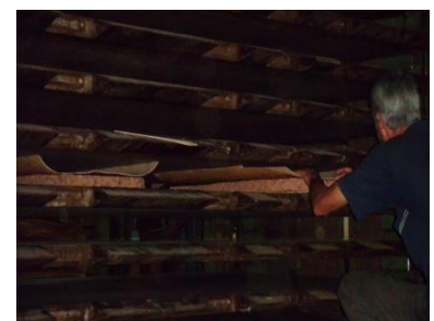
Figure V.4. Chargement des panneaux sandwiches dans la presse à chaud.
