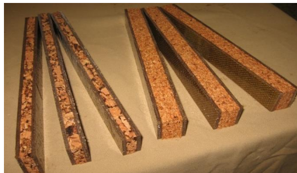
Figure III.3. Échantillons de sandwich à base de liège aggloméré élaboré par la méthode infusion [92].
