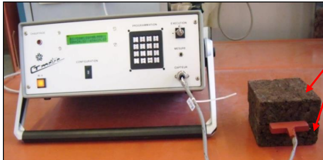
Figure V.13. Mesure des propriétés liées aux transferts thermiques d'un échantillon à l'aide d'un CT mètre.
