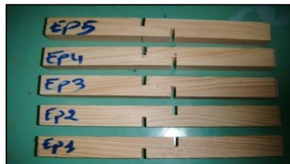
Figure IV.4. Éprouvette normalisée pour les essais de cisaillement.
