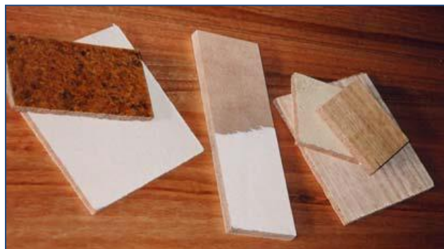
Figure III.10. Échantillons de composites de liège / thermoplastiques [85].
