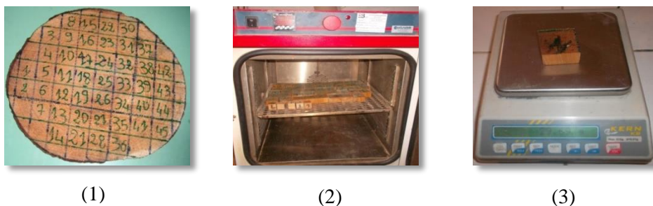
Figure IV.2. Caractérisation d'humidité du bois de pin d'Alep : (1) disque de pin d'Alep découpé en cubes, (2) séchage des cubes et (3) pesée des cubes.
