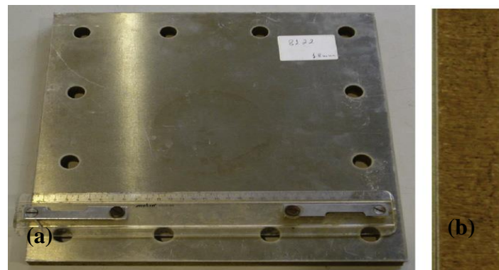
Figure III.4. Vue d'une composée structure sandwich NL20 MAC : (a) l'ensemble et (b) épaisseur (transversale) [93].
