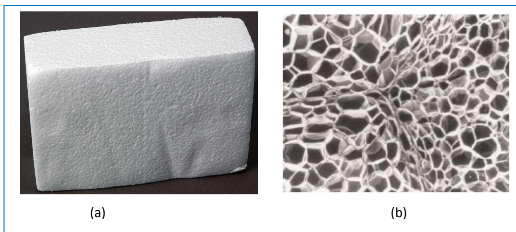
Figure I.5 : (a) Feuille de polystyrène expansé, (b) structure alvéolaire de polystyrène.
