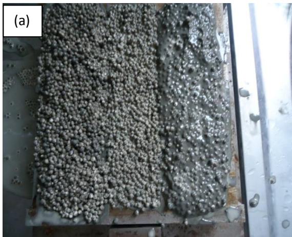
A02-3 : Confection des éprouvettes avec des billes de polystyrène enrobée et non enrobée.
