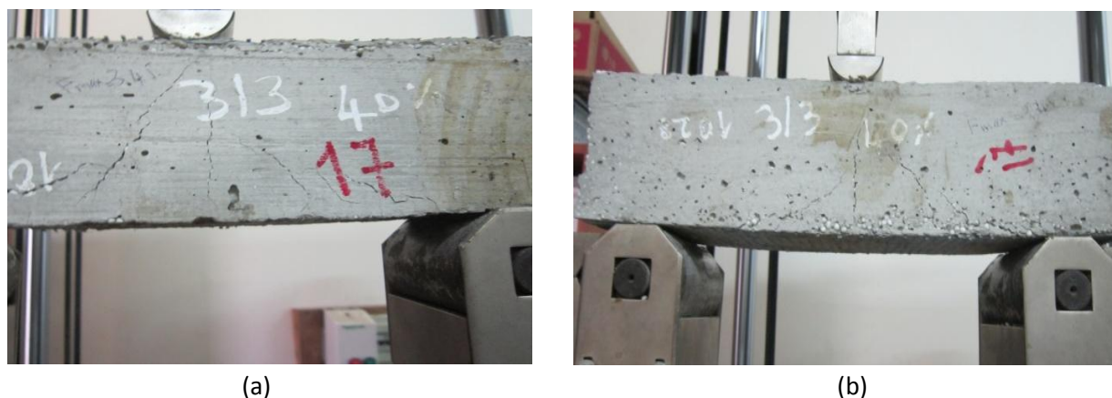
Figure IV.32 : Eprouvettes ont soumis aux charges de : (a) flexion statique et (b) fatigue.
