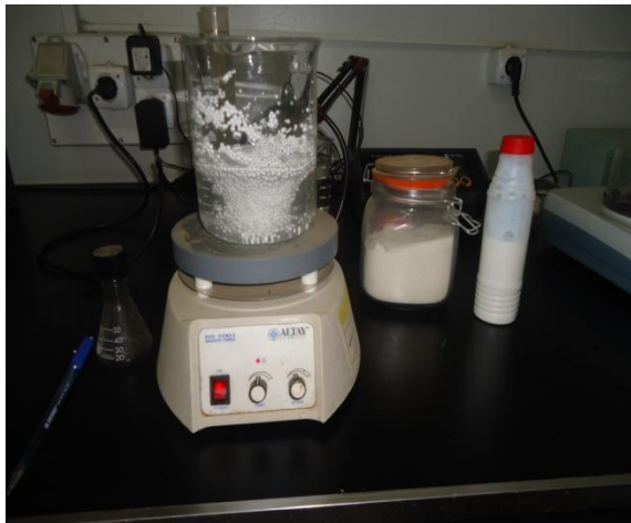
A02-1 : enrobage des billes de polystyrène.
