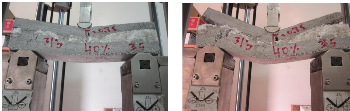
Figure IV.41 : Eprouvette sous forme sandwich soumise aux charges de fatigue.
