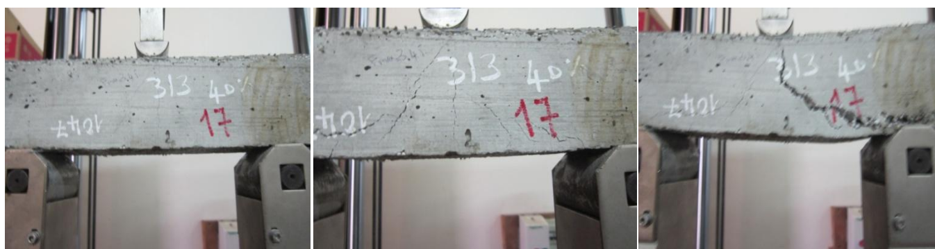
Figure IV.38 : Fissuration d'une éprouvette soumise aux charges de fatigue.
