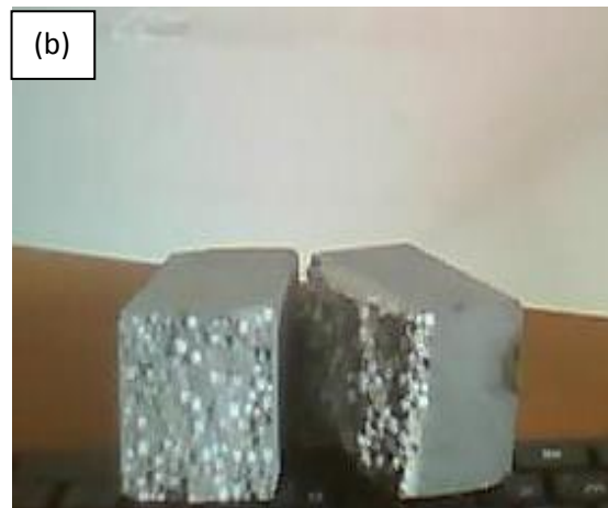
A02-3 : Confection des éprouvettes avec des billes de polystyrène enrobée et non enrobée.
