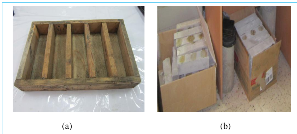
Figure III.3 : (a) Moules prismatique 7x7x28cm, (b) éprouvettes confectionnées.
