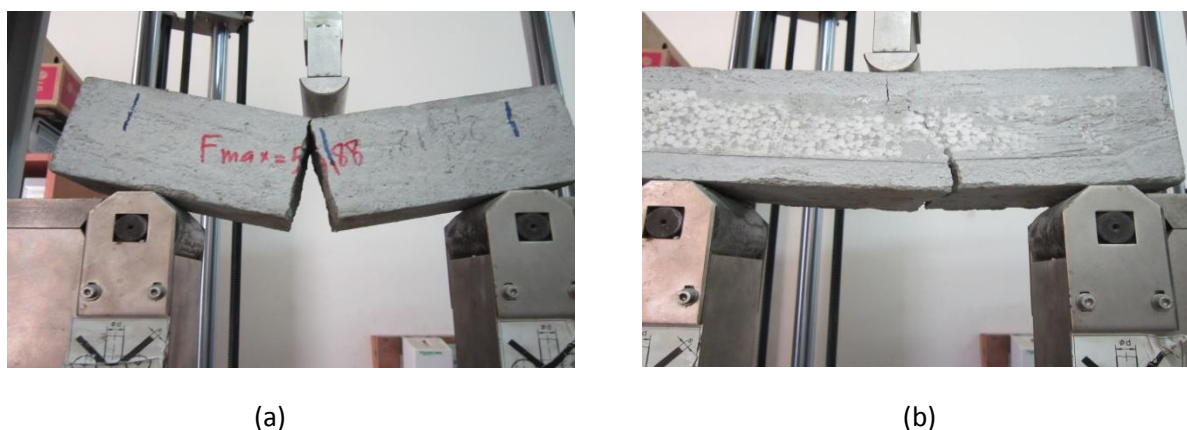
Figure IV.43 : Essai de fatigue des éprouvettes témoins : (a) stratifié témoin et (b) sandwich témoin.
