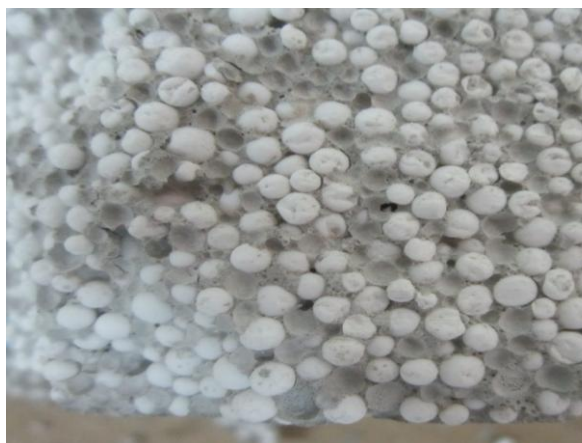
Figure IV.11 : La répartition des billes de polystyrène dans une éprouvette.
