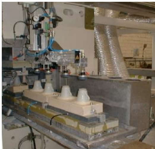
Figure 26: Pressage isotactique de coulage sous pression de tasses (Photo Elmeceram_Oradour sur Vayres).
