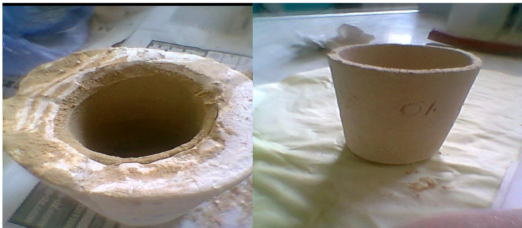
Figure 58: Coulage de barbotine dans le moule en plâtre et le revidage de la barbotine.
