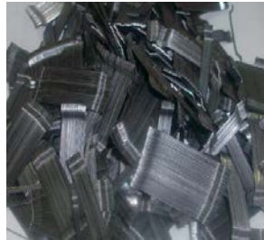
Fig. V-13 –Fibres métalliques à crochets encollés.
