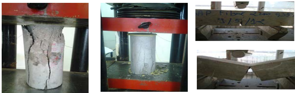
Essai de traction par flexion des BAP et BAPF
