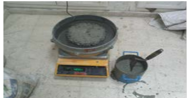
Essai de la stabilité au tamis
