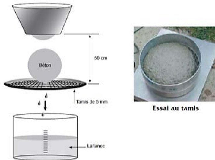
Fig. IV-10 – Essai de stabilité au tamis.
