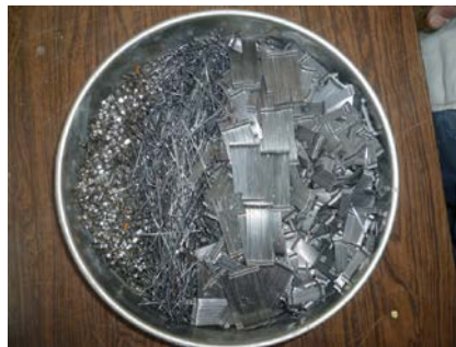
Fig. II-4 – Différents types de fibres métalliques.
