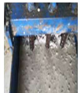
Fig. VI-2 – Essai de la boîte en L du béton témoin
