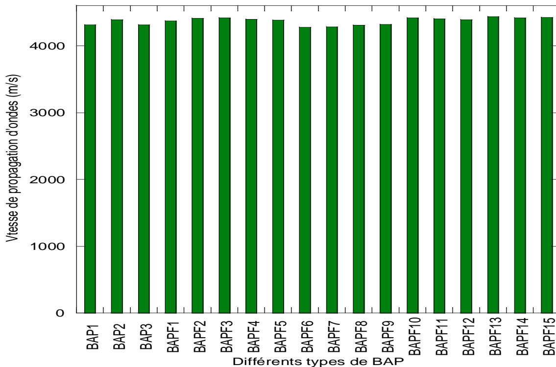
Fig. VII-43 – Effet des différents types de fibres sur la vitesse de propagation de l'onde sonore
