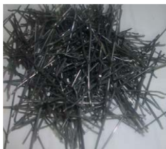
Fig. V-12 – Fibres métalliques à crochets
