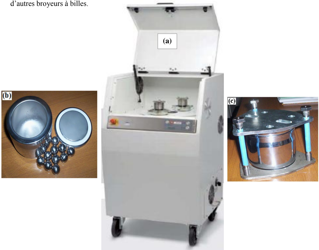
Figure II. 1. (a) Vario-broyeur planétaire innovant « Pulverisette 4 », (b) jarre et billes de broyage et (c) jarre hermétiquement fermée avec un serrage approprié.
