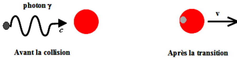
Figure II. 10. Schéma de l'absorption d'un photon engendrant une transition nucléaire.
