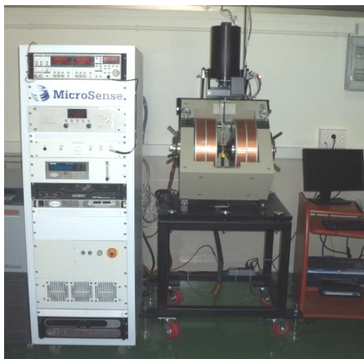
Figure II. 24. Magnétomètre à échantillon vibrant de modèle EV9.
