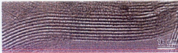
Figure I.22: Image de franges d'un faisceau de tubes correspondant aux plans (synthèse arc électrique).
