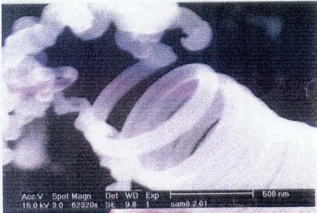
Figure IV.5 Image MEB des nanotubes de carbone synthétisés par pyrolyse catalytique à 850°C en présence de pétrole brut de l'Algérie et FeCl<sub>3</sub> solution colloïdale, vue sur MWNTs qui sont dans la gamme 15-25 nm de diamètre.
