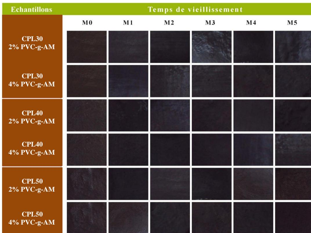
**Figure IV.37** : Aperçu des couleurs relatives aux composites constitués de PVC-g-AM, (avant et après vieillissement thermique).
