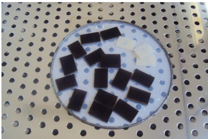
**Figure III.7 :** Test d'absorption d'eau.
