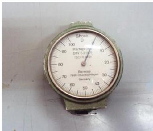
Figure III.11 : Duromètre shore D.
