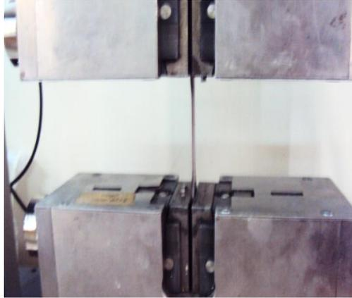
**Figure III.10** : Essai de traction effectué sur la ZWICK 10KN.
