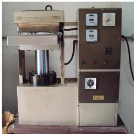
**Figure III.5 :** Presse utilisée pour la préparation des plaques
