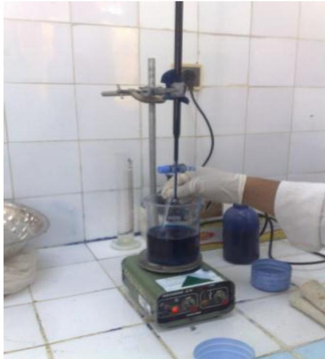
**Figure IV-23** : Essai Bleu de Méthylène.
