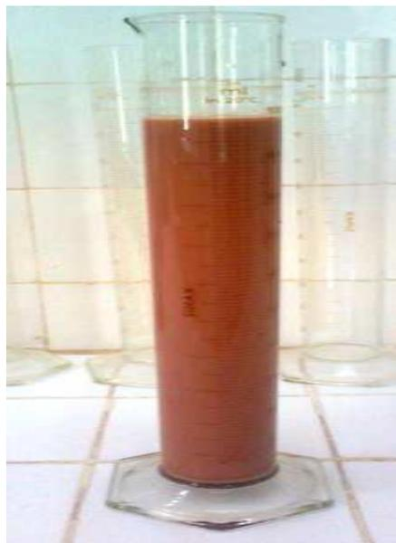
**Figure IV-10 :** *Essai de Sédimentation.*
