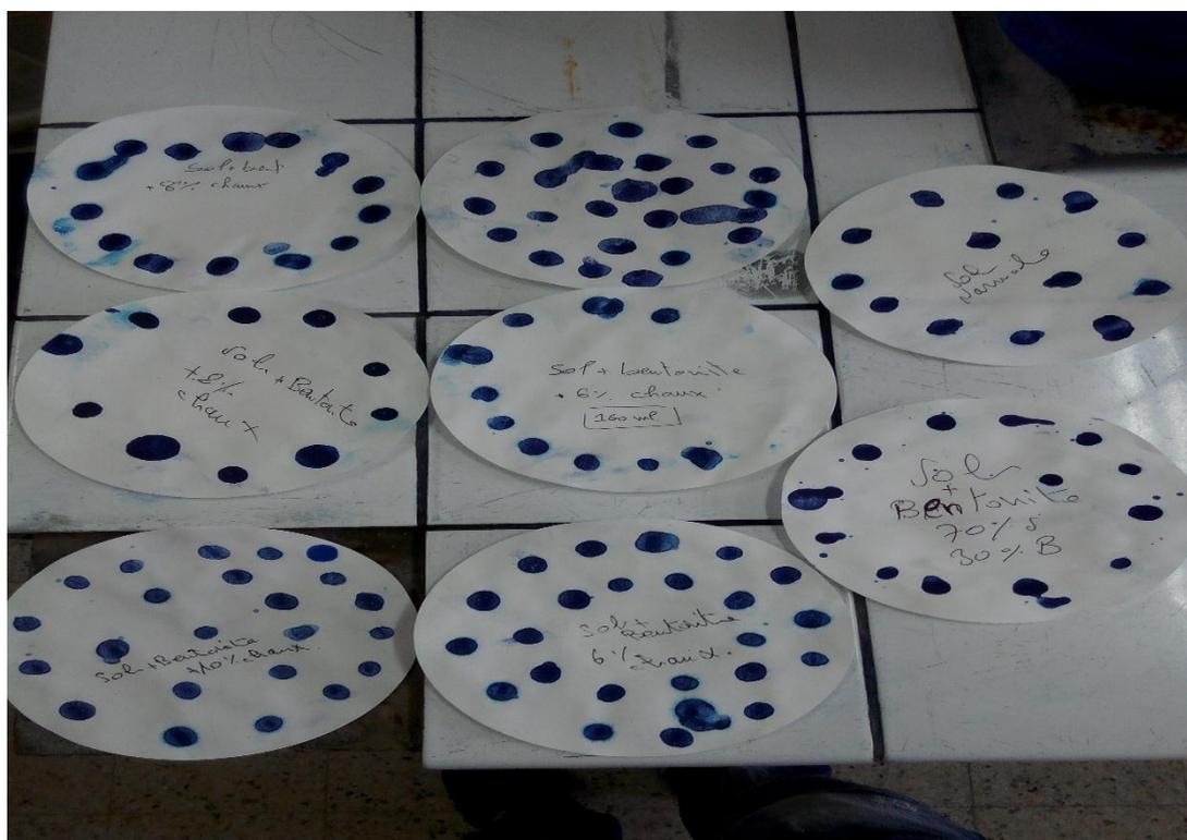
**Figure IV-24 : les essais réalisés de bleu méthylène**
