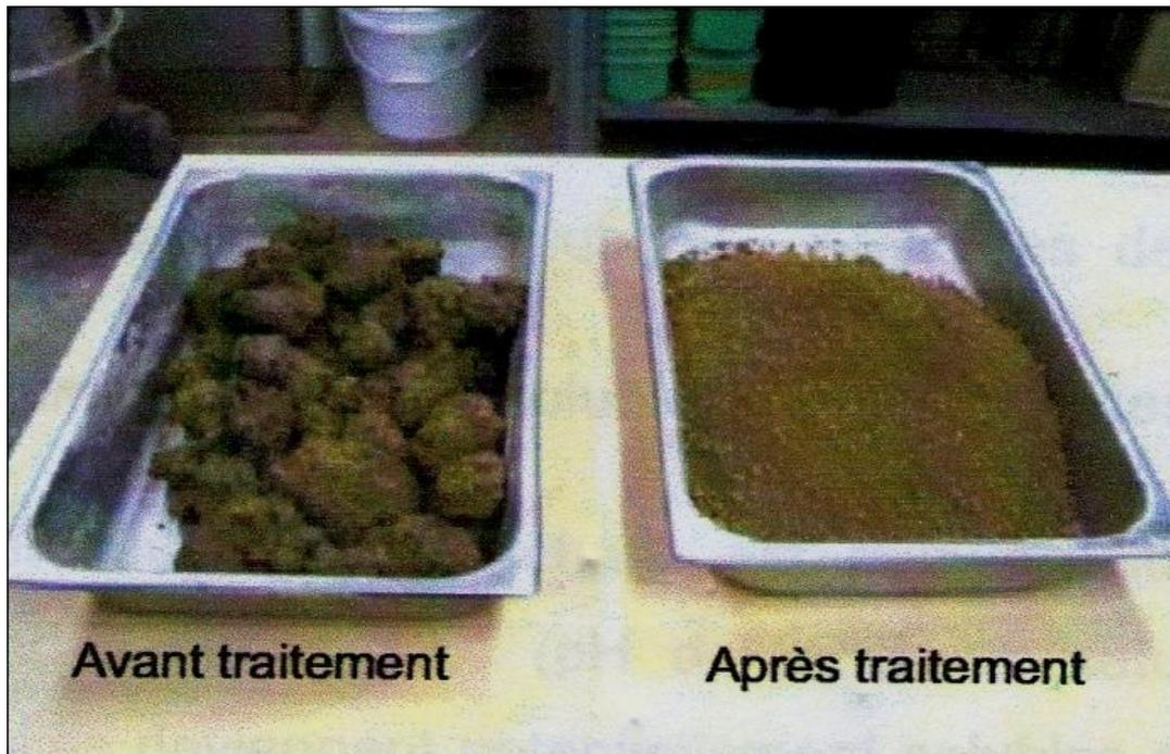
**Figure III-4 :** Changement de structure du sol traité à la chaux au laboratoire.
