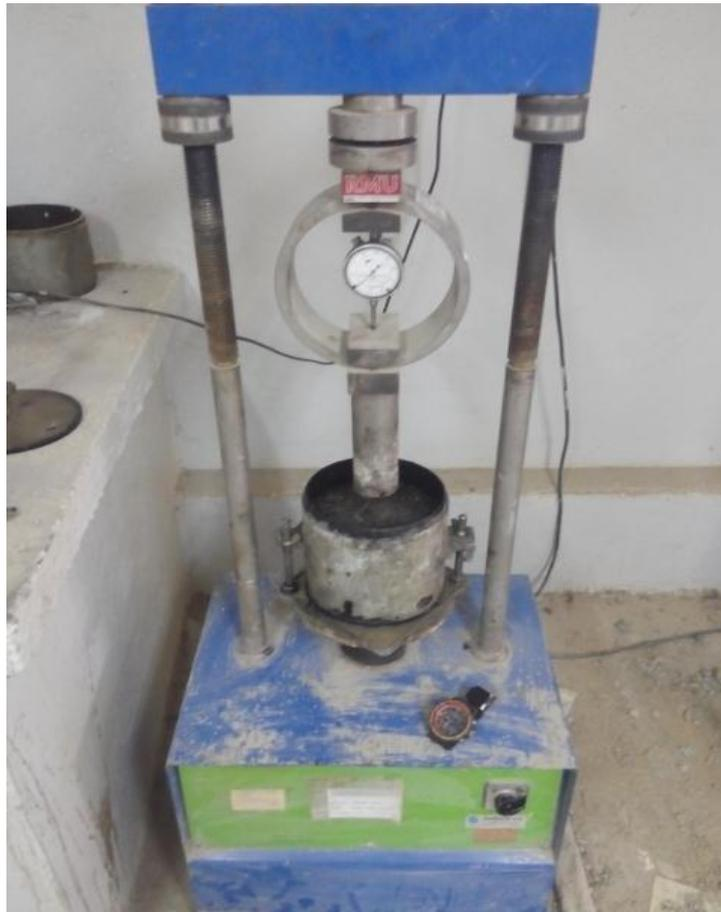
Figure IV-29 : piston de poinçonnement
