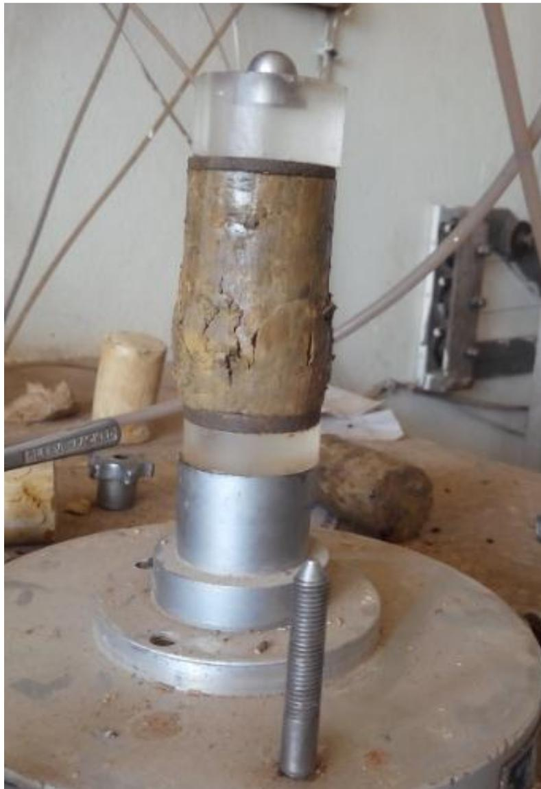
Figure IV-40 : L'éprouvette après l'encrassement
