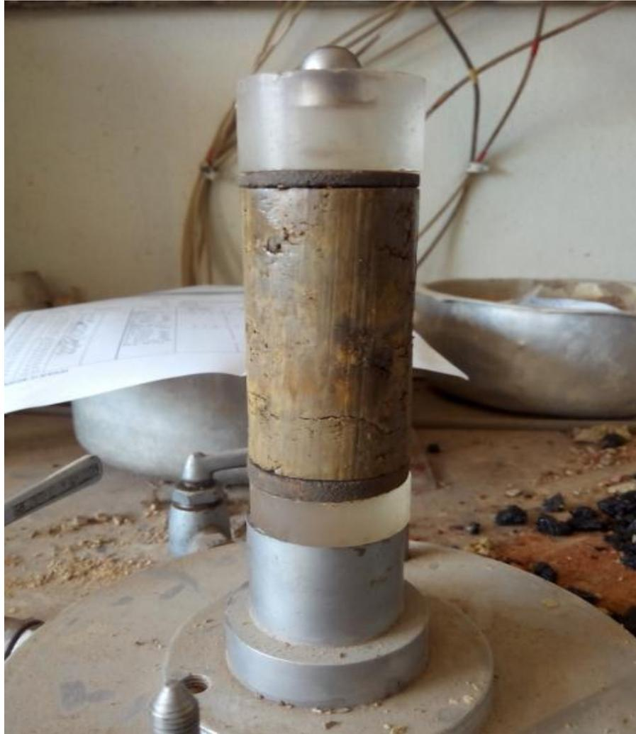
**Figure IV-39** : *L'éprouvette avant l'encrassement*
