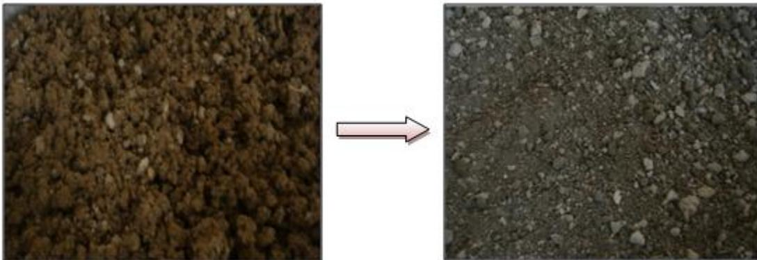
**Figure V-12 :** *l'échantillon avant et après traitement par le ciment*
