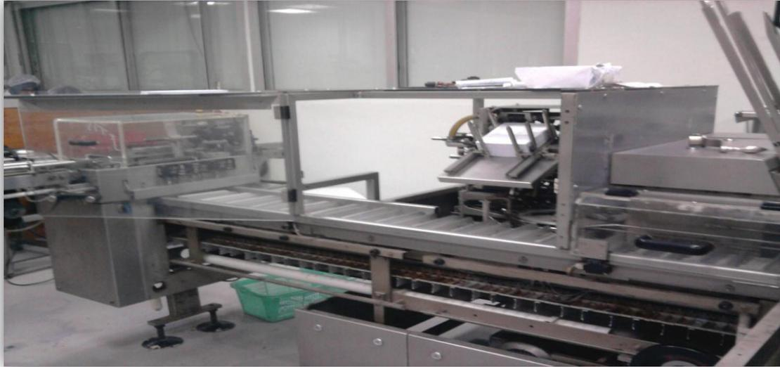
**Figure III.15:** Chaîne de conditionnement (primaire et secondaire)
