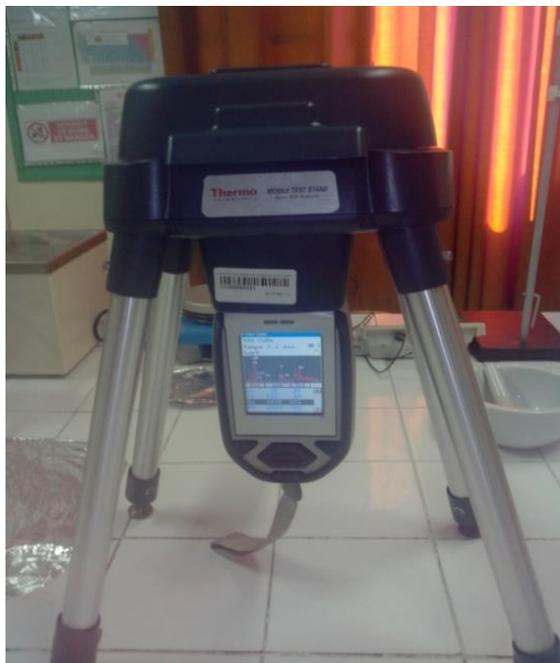
**Figure IV.4** :Dispositif d'analyse des éléments majeurs des CVM.
