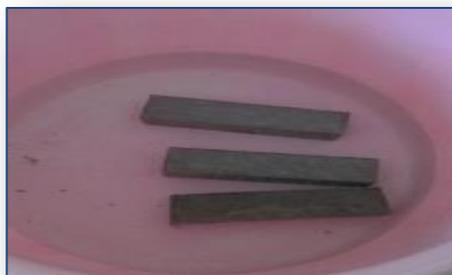
**Figure IV.10** : Conservation des éprouvettes
