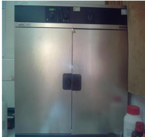
**Figure IV.2 :** Étuve de séchage du CVM.
