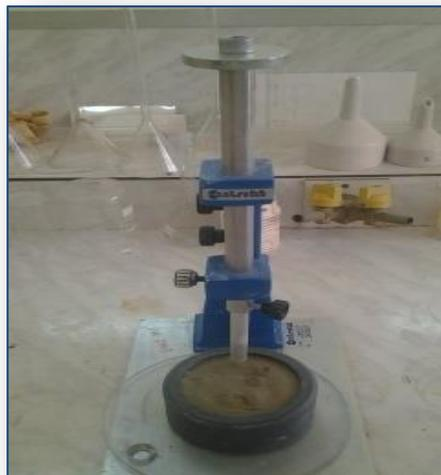
**Figure IV.7 :** Appareil de Vicat muni de sa sonde de consistance.
