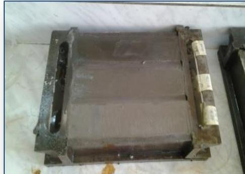
**Figure IV.8** : série de 03 éprouvettes couvertes de film plastique
