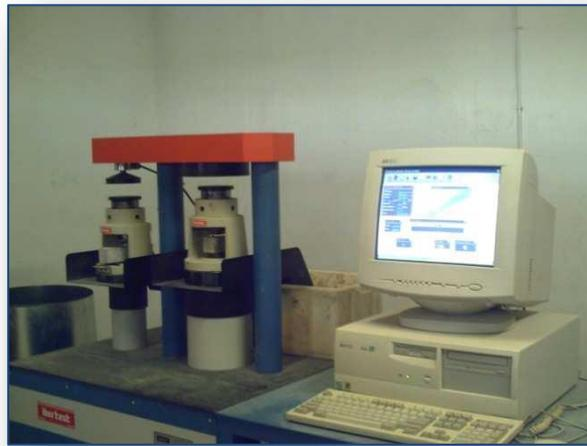
**Figure IV.11** : Dispositif de la résistance à la flexion (trois points)
