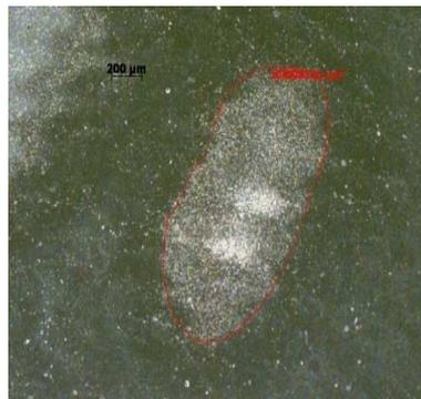
**Figure III.1:** Image avec un microscope optique de l'impact laser sur un film polaroid à 20mJ.
