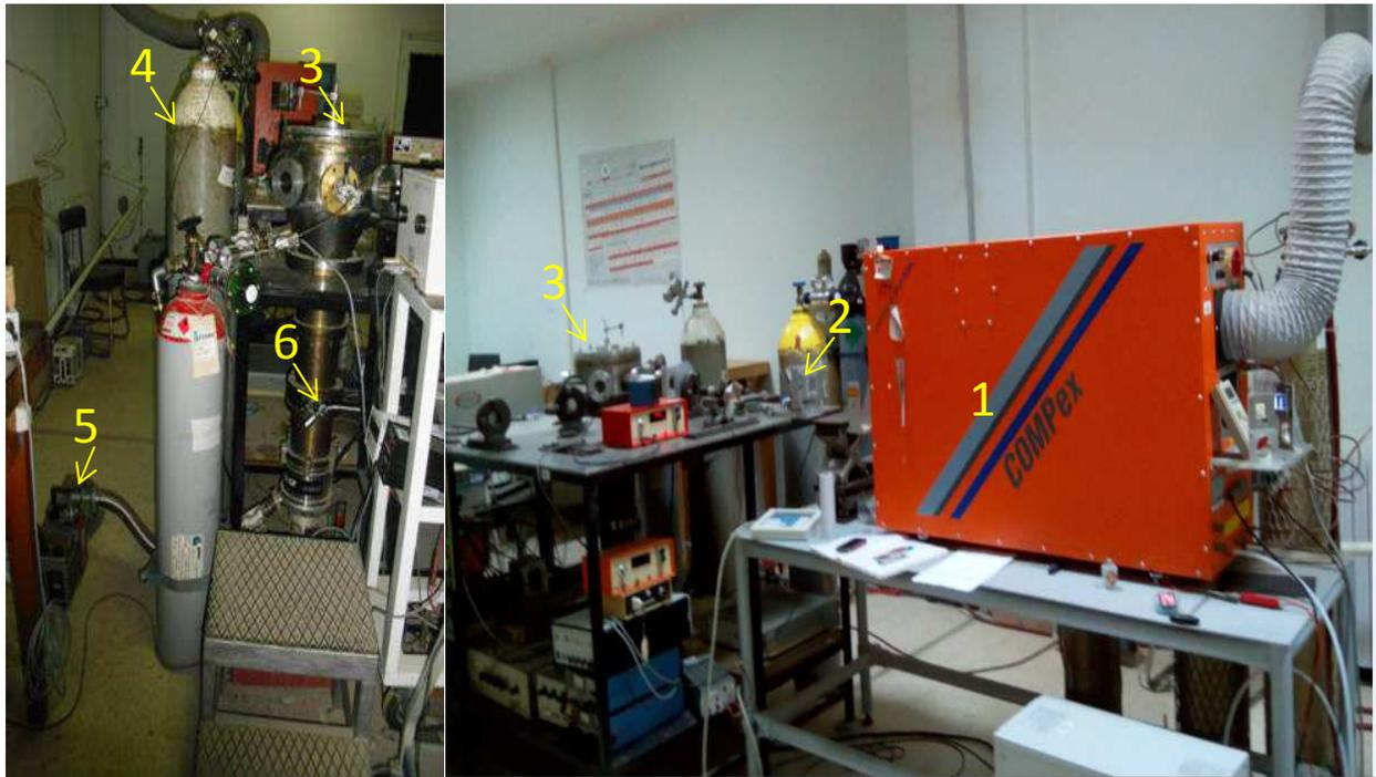
1: Source Laser, 2: Lentille cylindrique (1m de focal), 3: chambre de dépôt, 4: bouteille d'O<sub>2</sub>, 5: Pompe primaire, 6: Pompe secondaire
