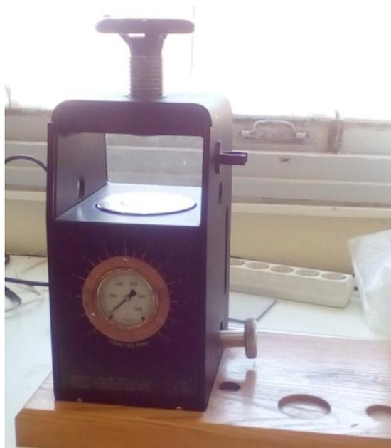
**Figure IV.20** : Pastieuse utilisé pour la construction des pastie de KBr pour l'analyse IFTIR.
