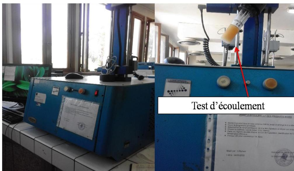
Figure IV.11 : Détermination de point d'écoulement « LINETRONIC TECHNOLOGIES à programme Lintech ».
