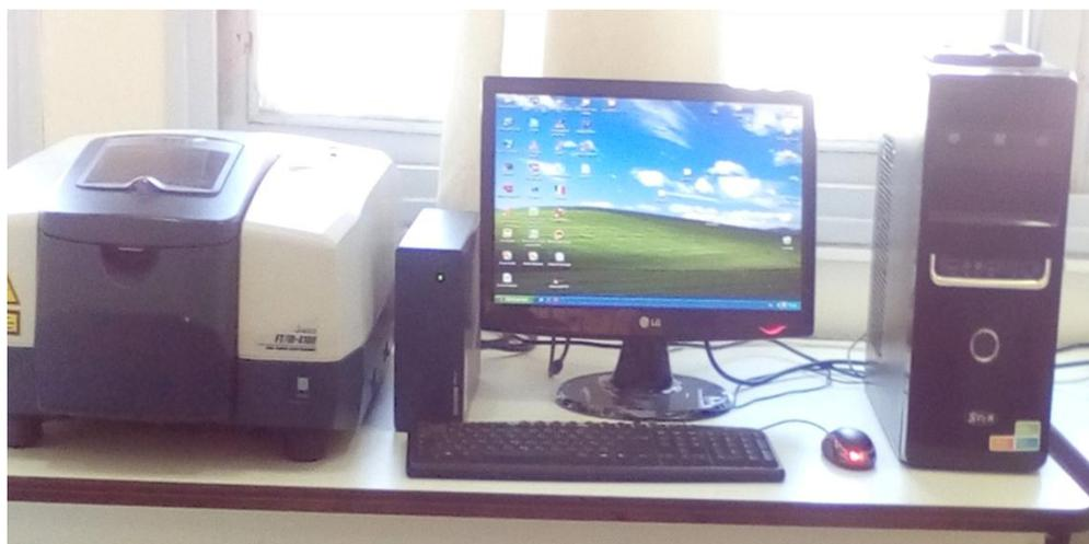
**Figure IV.19** : Spectromètre IFTR de model JASCO IFTR-4100.
