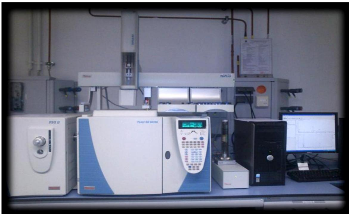
**Figure IV.21 :** le Chromatographe en phase gazeuse couple a un spectromètre de masse GC-MS. De modèle TURBO-MASSE.
