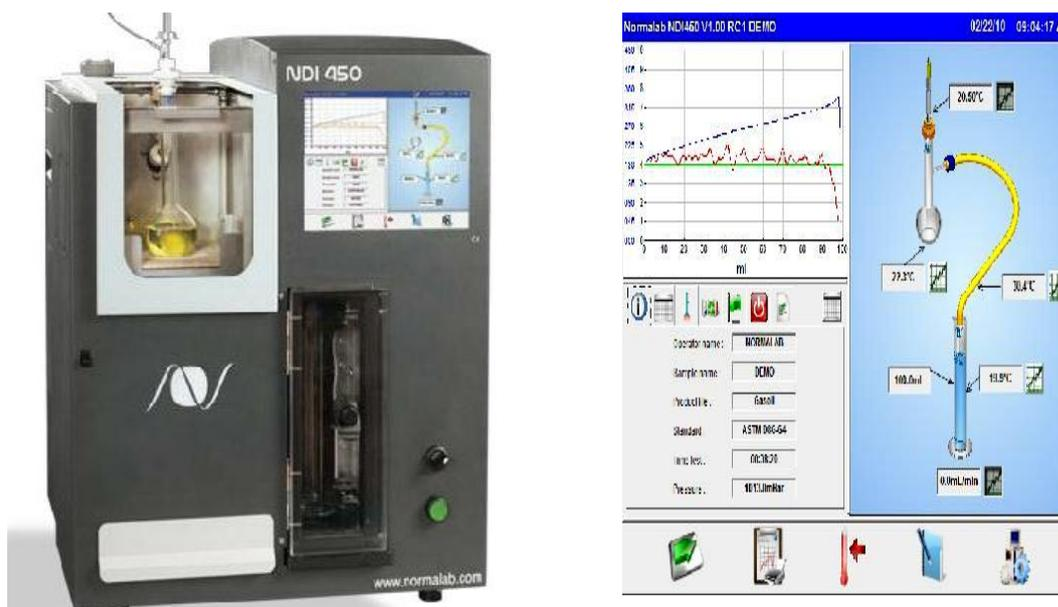
**Figure IV.12 :** Dispositif de distillation automatique ASTM D86 avec logiciel ADU5.
