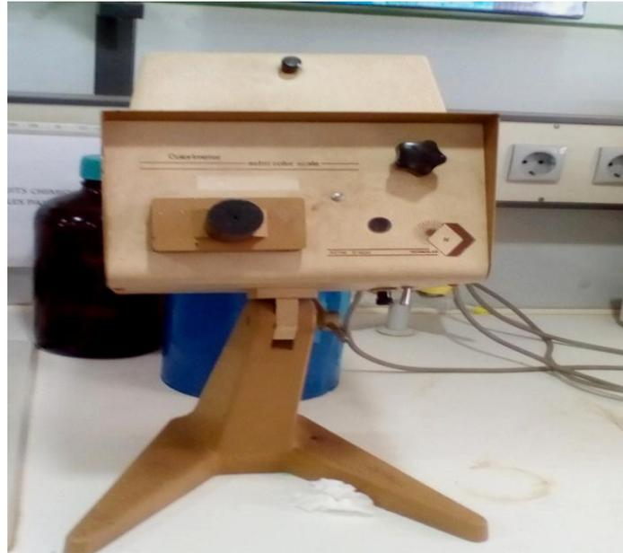
**Figure IV.7 :** Colorimètre - ASTM colore scale.
