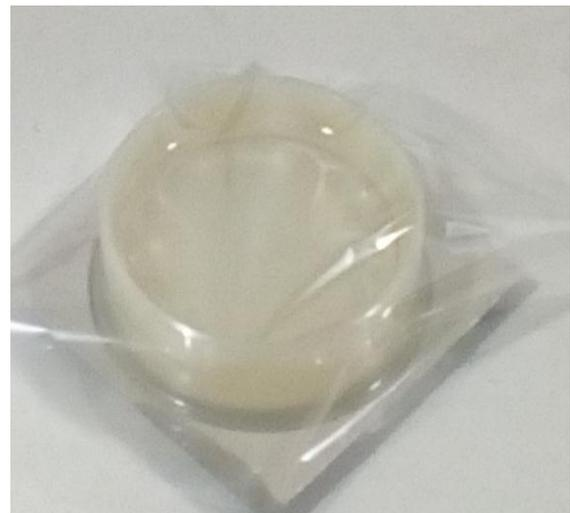
**Figure IV.16:** la boîte utilisée dans le spectromètre analyseur de soufre.
