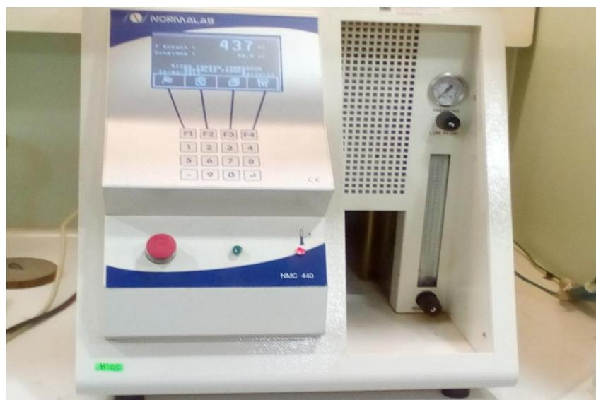
**Figure IV.14** : four à moufle à 1000°C de modèle NORMALAB.
