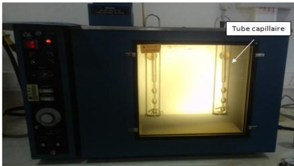
**Figure IV.4:** Viscosimètre manuelle (modèle HVU 40).
