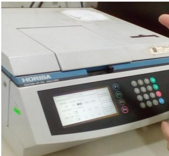
**Figure IV.15 :** Spectromètre à RX (HORIBA) sulfure in-oil analyseur
