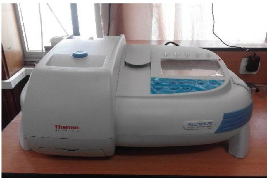
**Figure IV.22 :** Spectromètre UV-visible de modèle thermo – évolution 201.
