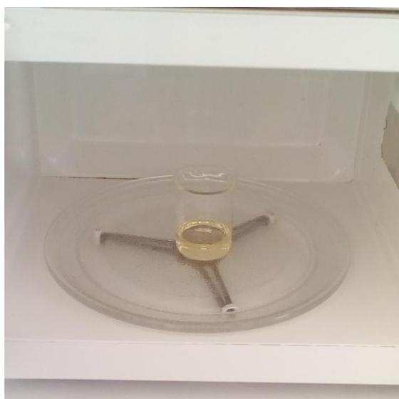
Figure IV.3 : synthèse des IIs sous radiation microonde.
