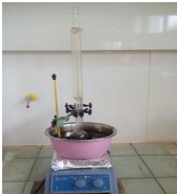
Fig I.5 : montage pour la polymérisation du lactide
