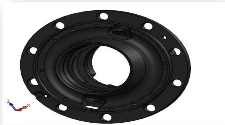
Figure III.20 : Moyeu avec 8 perçages.
