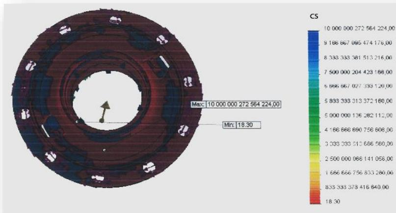
Figure III.19: Distribution de coefficient de sécurité
