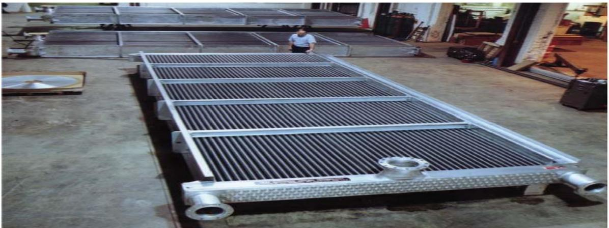
Figure III.5 : Faisceaux d'aérorefrigérant en construction [9].
