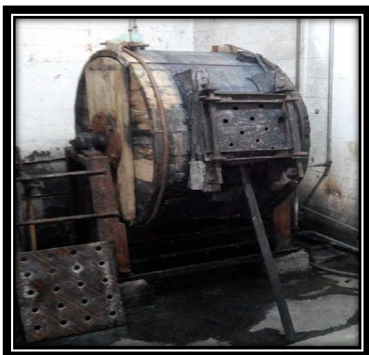
Figure n°15 : Foulon rotative pour l'essai semi- ; industrielle
