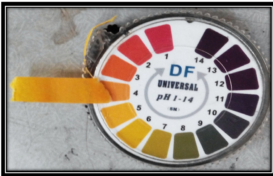
Figure n°10 : Contrôle du pH lors du tannage pH=4
