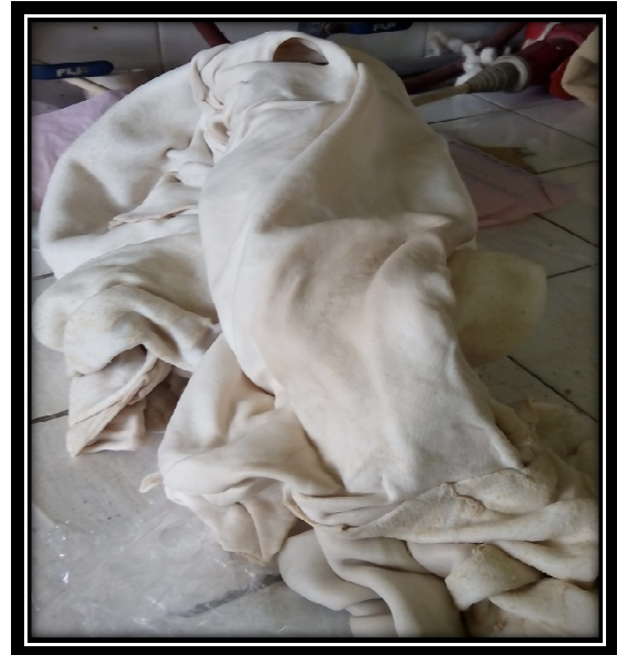
Figure n°9: La peau picklée pour l'essai semi-industrielle
