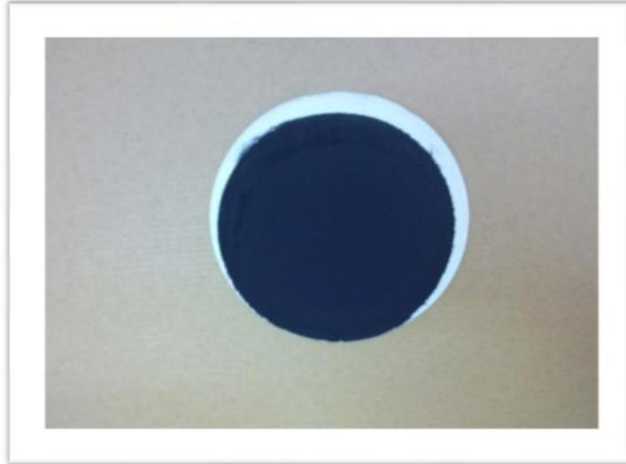
**Photo 73 :** Filtre chargé en particules des fumées (produit).
