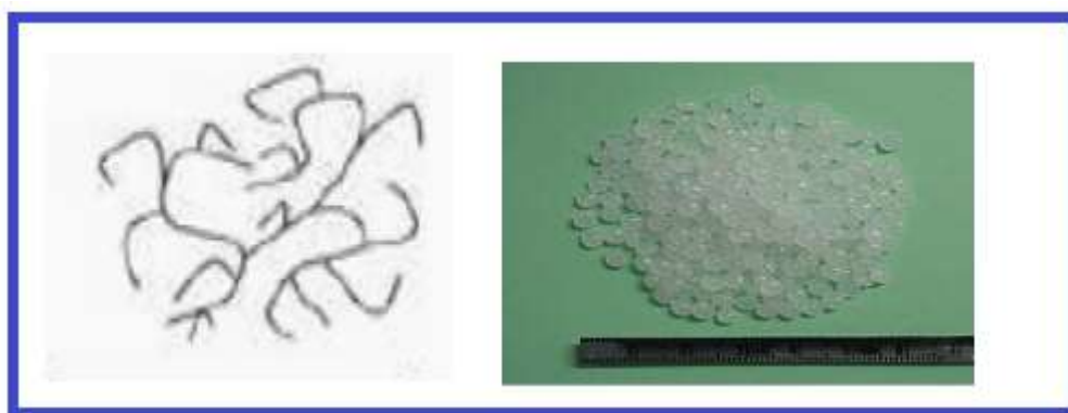
Figure II.2 : Structure de polyéthylène basse densité [12].
