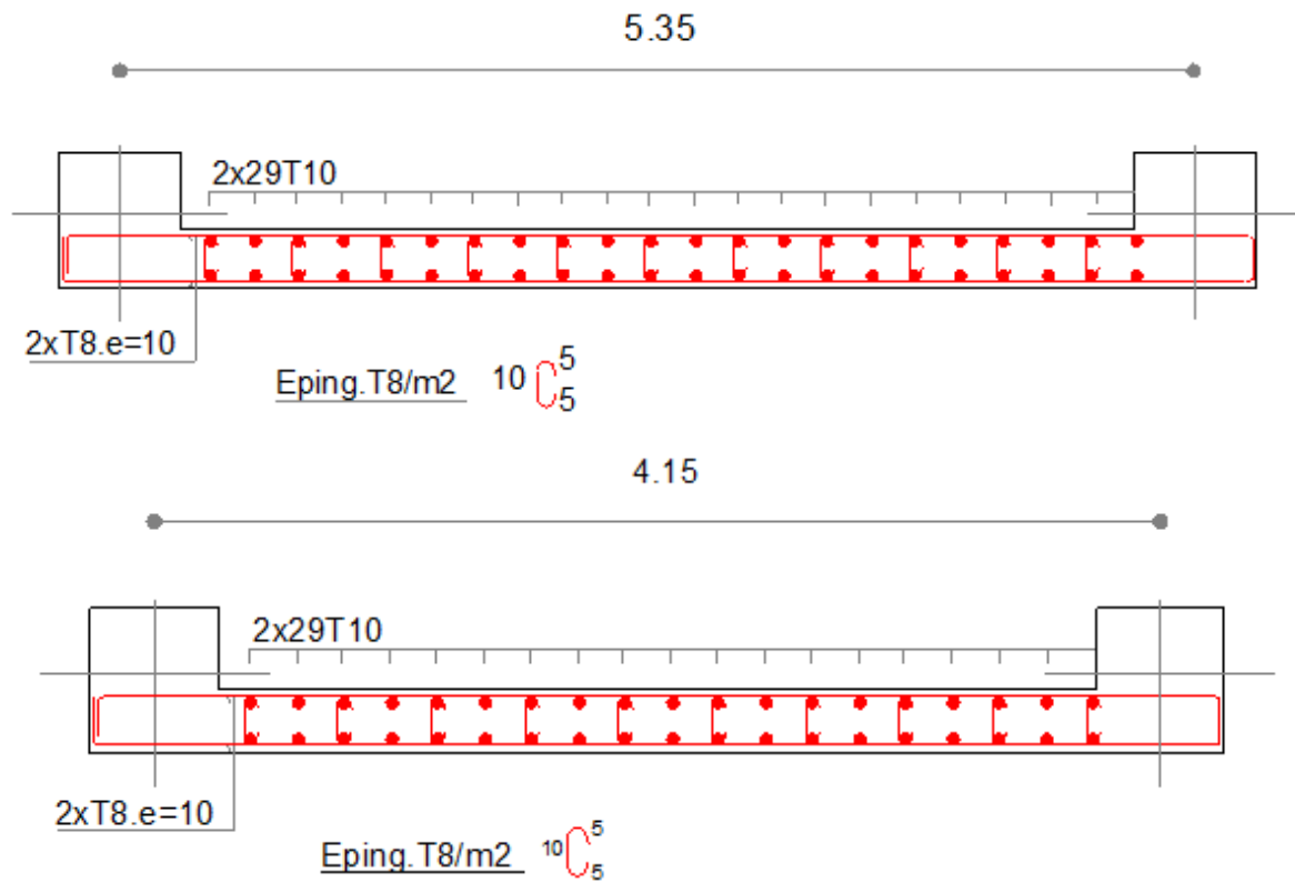
Figure.VI.3. Schéma de ferrailage des voiles V1 et V2
