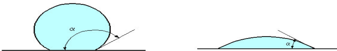
Figure III.16. Goutte avant ajout de tensioactif [26]. Figure III.17. Goutte après ajout de tensioactif [26]
