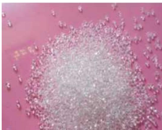
**Figure II.1** : Le polystyrène cristal
