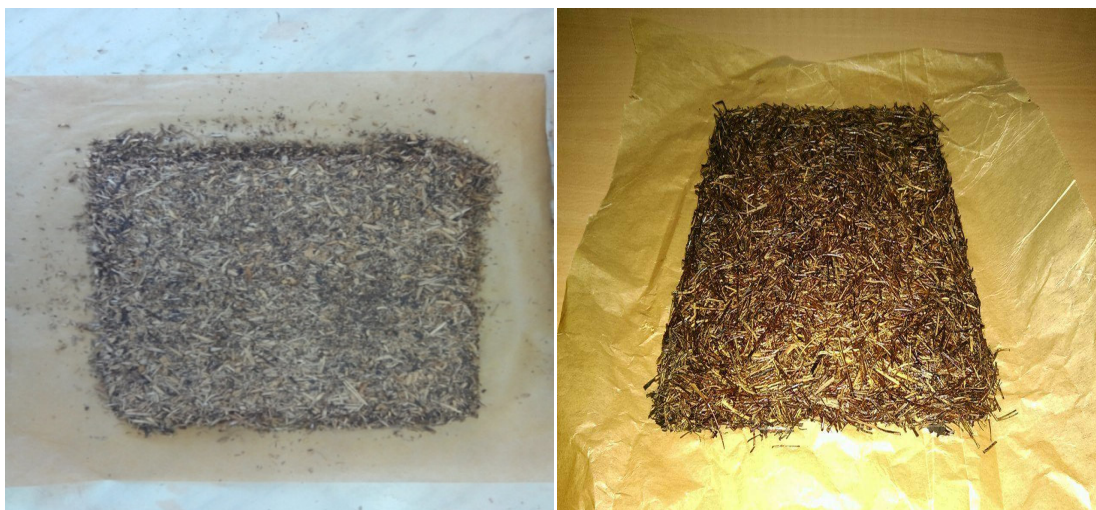
Figure 16 : Panneaux de particules : à gauche copeaux de bois, à droite fibre d'alfa
