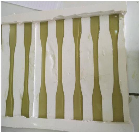
Figure II.2 : Moule normalisé utilisé pour fabriquer les éprouvettes pour le test de traction et flexion.
