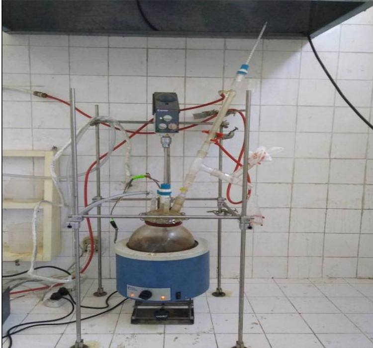
Figure II-1 : Réacteur de résine
