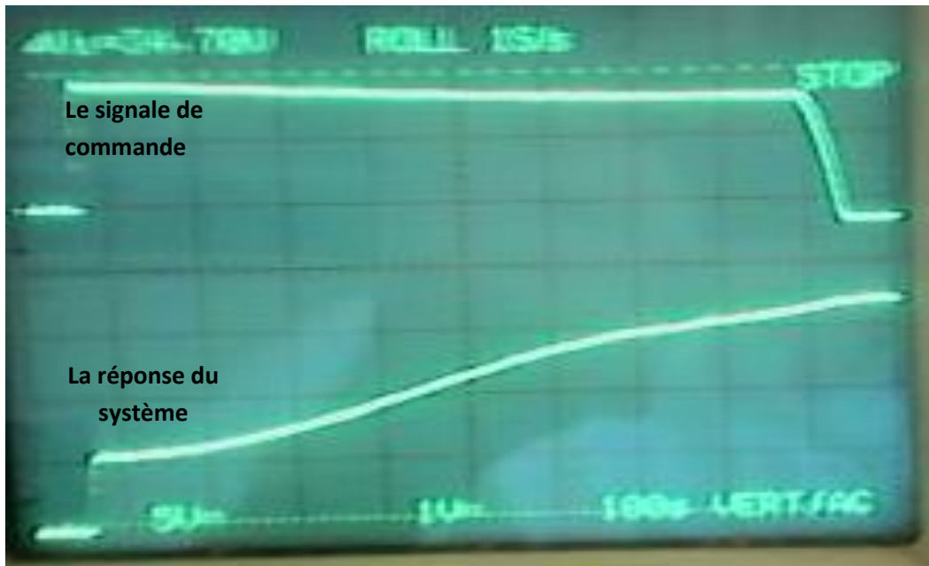
Figure IV.17 Courbe de réponse du four et le signal de contrôleur PI non linéaire déterminé par la synthèse
