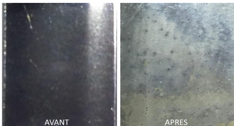
Figure III.17 : photographie de ECHAN-02 avant et après test de corrosion. :
