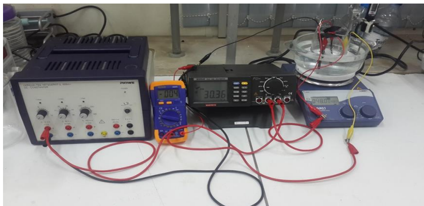
Figure II.11 : Photographie du dispositif de mesures électrochimiques de corrosion.
