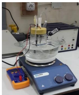
Figure II.14 : Photographie du dispositif de Chronopotentiométrie pour le suivi du potentiel libre.
