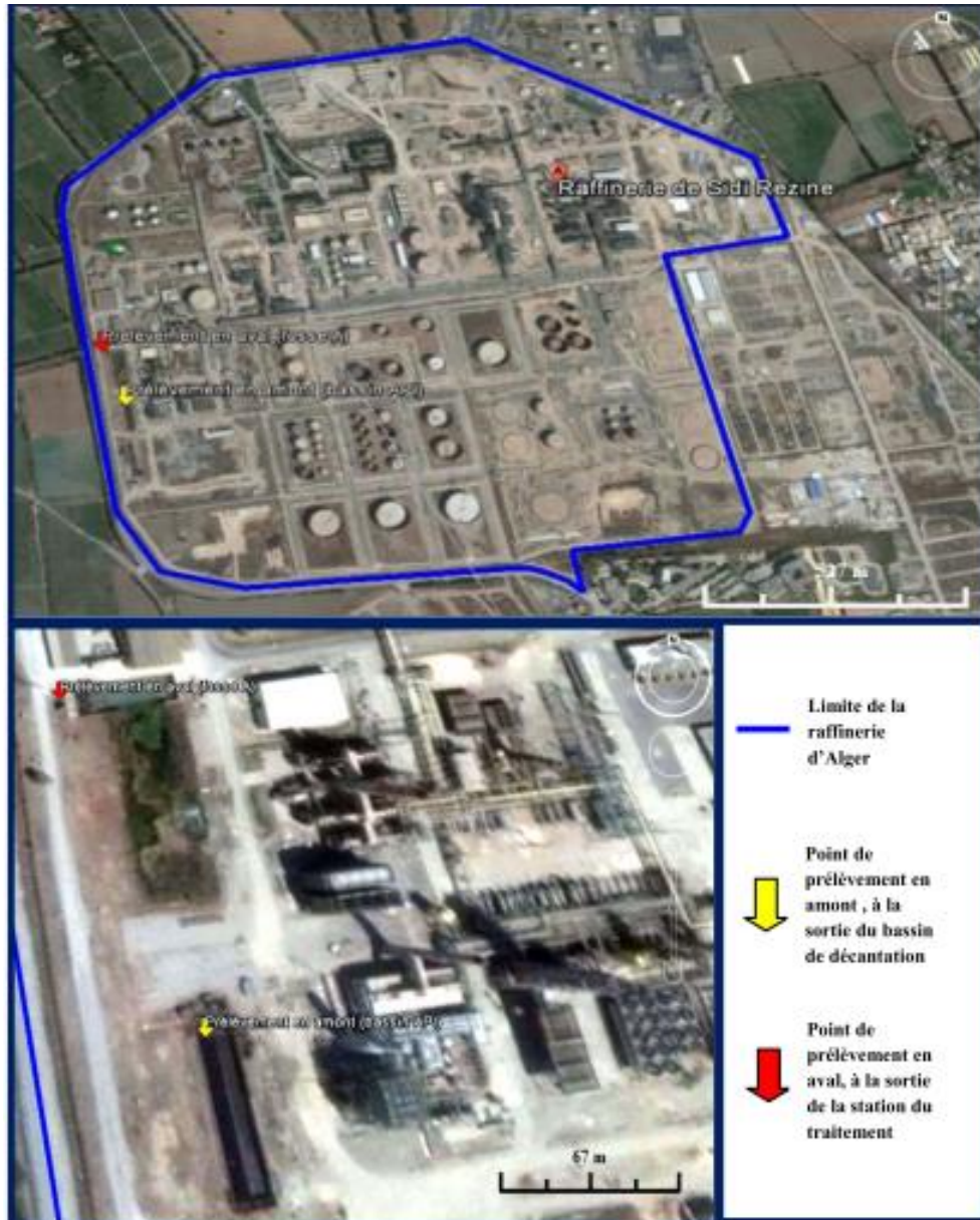
Figure 15 : Vue aérienne de la station du traitement des ERI de la raffinerie d'Alger avec zoom sur les points de prélèvement (Google Earth, 2016).
