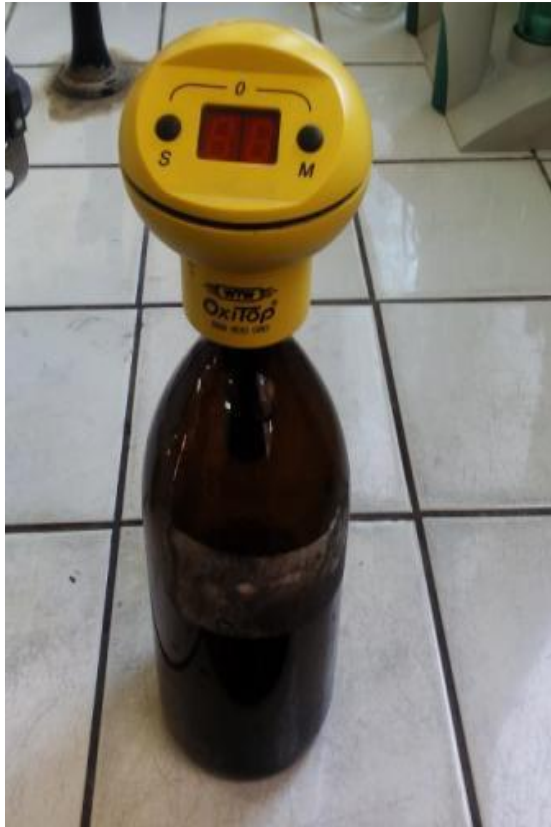
Figure 11: DBO mètre de type OXITOP IS6.
