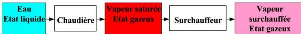
Figure II-2 : Cycle de transformation de l'eau.
