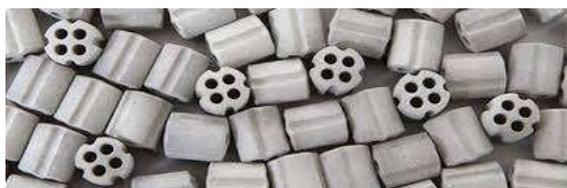
Figure II-9 : Forme la plus performante du catalyseur à base de nickel.
