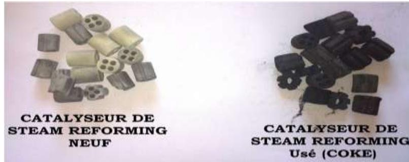
Figure IV-19: Echantillon de catalyseur neuf (à gauche) et de catalyseur désactivé (à droite).
