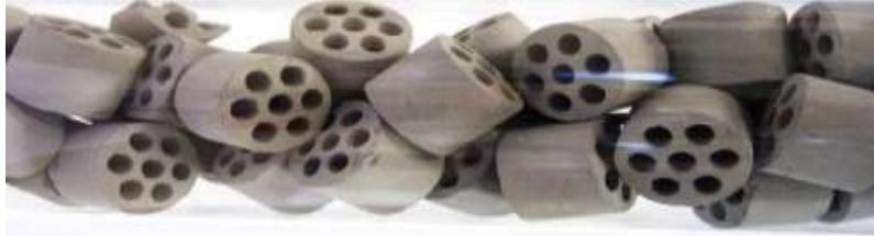
Figure II-6 : Exemple de catalyseur de reformage.
