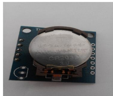
Figure(II.7) : Module DS1307 (RTC)
