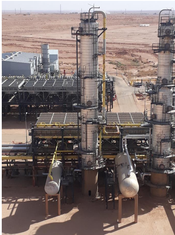
Figure 1.2 les colonnes dé-ethaniseur (à droite) et dé-butaniseur (à gauche).
