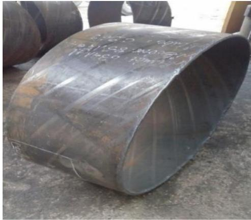
**Figure IV.1** Une virole découpée à partir d'un tube.
