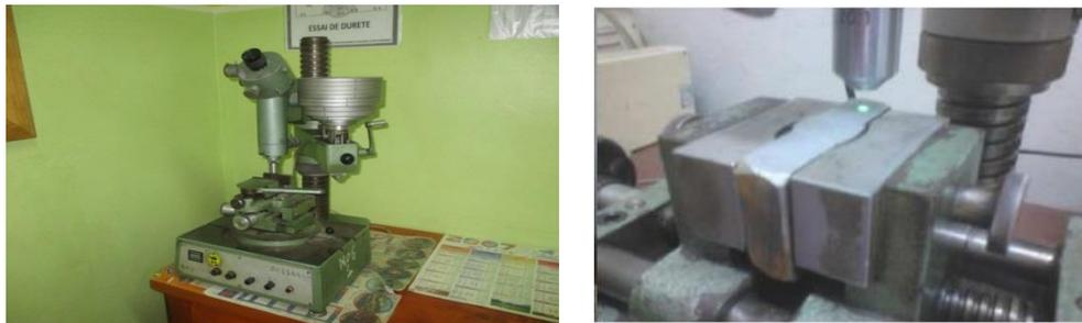
**Figure IV.12** Microduromètre utilisée pour les mesures de la microdureté (Type Vickers)
