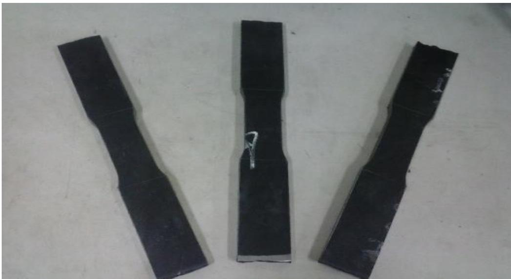
**Figure IV.19** Éprouvettes réalisées pour des essais de traction
