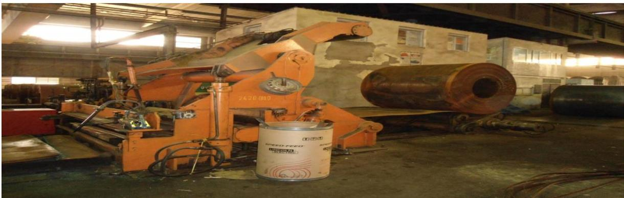
**Figure I.5** Élément de préparation de bobine.
