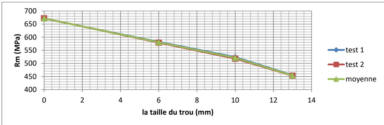
**Figure IV.25** La variation de la limite à la rupture ( $R_m$ ) en fonction de la taille du trou.
