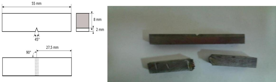
**Figure IV.16** Epreuve pour l'essai de résilience en V.
