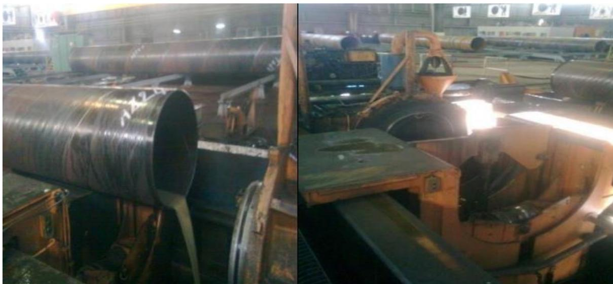
**Figure I.12** L'épreuve hydrostatique
