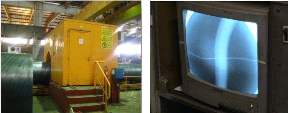
**Figure I.10** Contrôle de la soudure par radioscopie.
