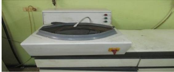
**Figure IV.10** Polissage mécanique aux papiers abrasifs
