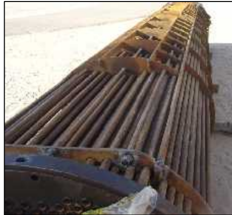
Figure 2.10 : Faisceau tubulaire de l'échangeur EA4501.
