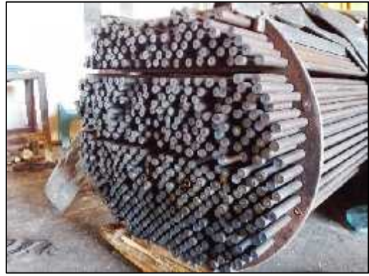
Figure 2.16 : insertion des nouveaux tubes
