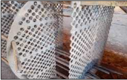
Figure 2.15 : extraction des anciens tubes du faisceau tubulaire
