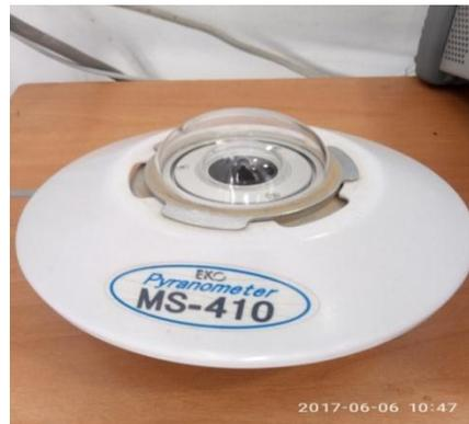
Figure 3.4 Pyranomètre MS-410.
