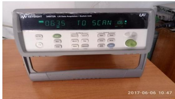
Figure 3.5 Appareil d'enregistrement digital type AGILENT 34970A à voies.
