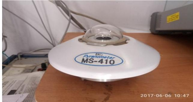
Figure 1.6 Pyranomètre
