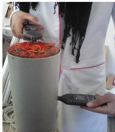
Figure 3.11 Mesure de la température et de l'humidité
