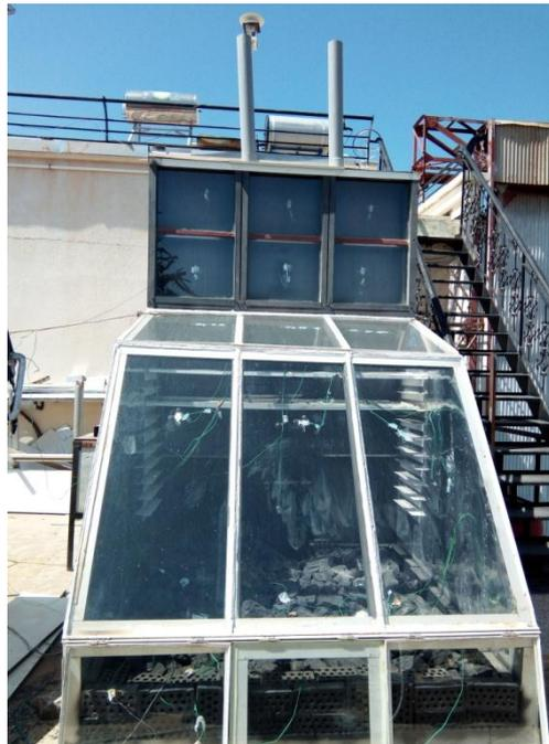
Fig. 3.2 Séchoir solaire directe (serre) avec tubes d'évacuation supplémentaires
