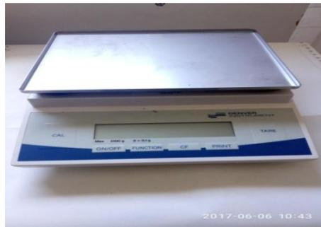
Figure 3.7 Balance électronique à affichage numérique.
