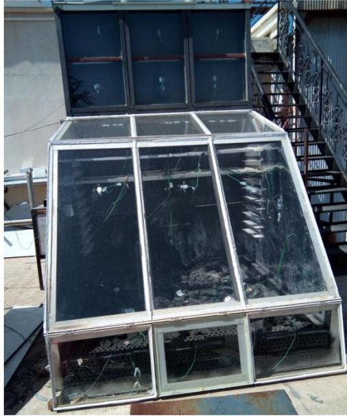
Fig. 3.1 Le séchoir solaire direct (serre) avant modification.
