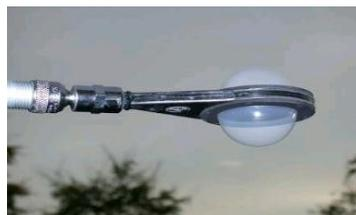
Figure 1.8 Pyrradiomètre différentiel
