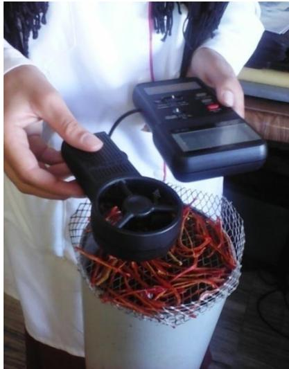
Figure 3.12 Mesure de la vitesse de l'air asséchant
