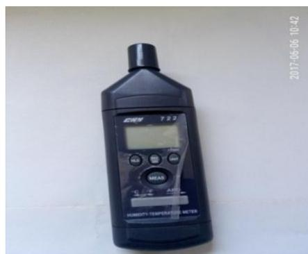
Figure 3.3 Thermo-hygromètre type CHY722
