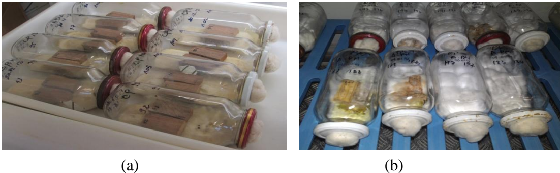
Figure 28. Exposition des éprouvettes de bois aux champignons (a) ; attaque des champignons pendant incubation (b)
