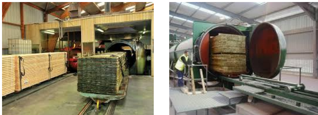
Figure 13. Station industrielle d'imprégnation du bois ( http://www.vercors-piscine.com/ http://www.protacouest.com/presentation/ )
