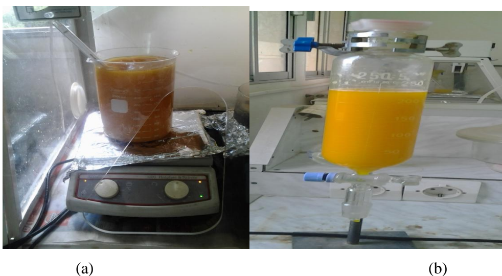
Figure 21. Epoxydation de l'huile de soja (a) ; Décantation de la phase huileuse après neutralisation et lavage (b).
