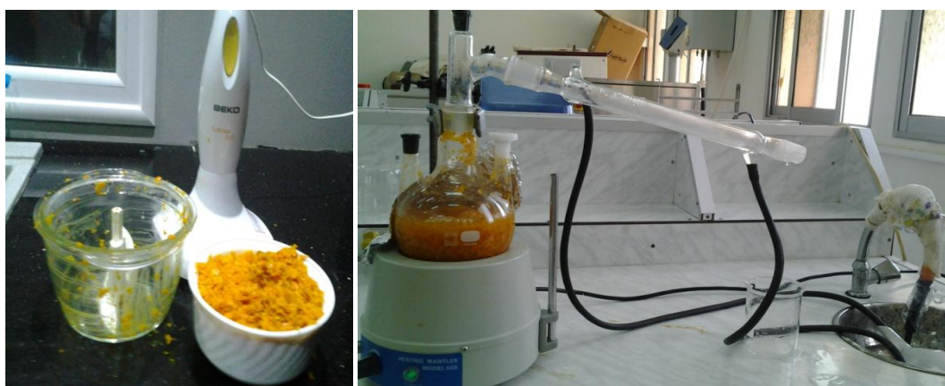
Figure 23. Extraction par hydrodistillation de l'huile essentielle d'orange.
