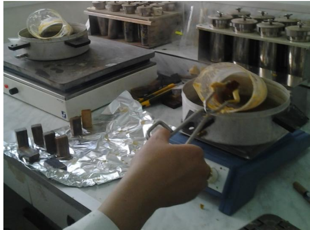
Figure 32. Imprégnation des éprouvettes de bois traitées à l'huile dans la cire d'abeille liquide mélangé avec l'essence de limonène.
