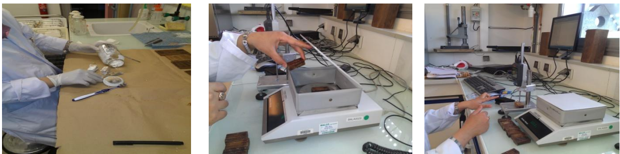
Figure 29. Pesée et mesure des éprouvettes après leur débarrassage de masses anhydres mycélium
