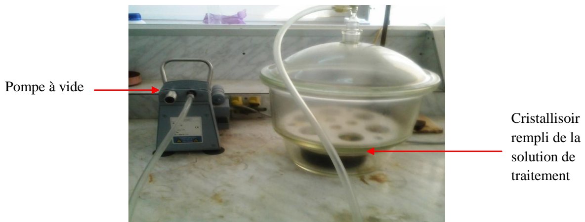
Figure 31. Photographie du dispositif utilisé pour l'imprégnation sous vide
