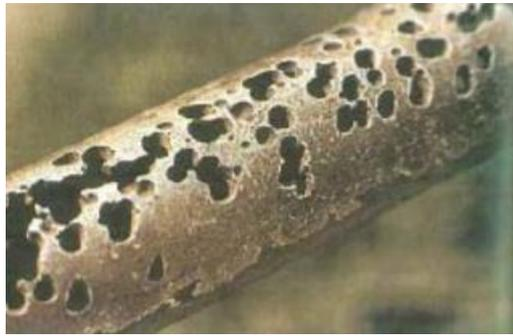
Figure IV.1 : Corrosion dans un tube.
