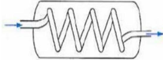
Figure II.10 : Echangeur monotube.
