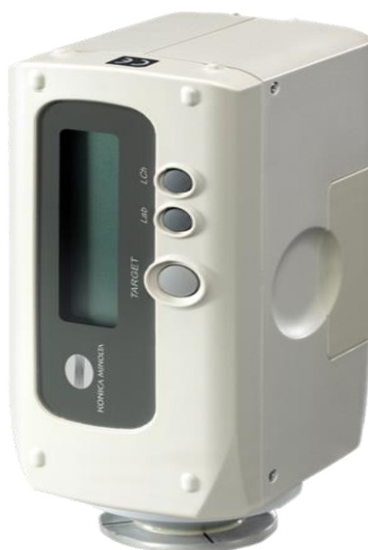
Figure III.3. Colorimètre de laboratoire type Cielab Korica Minolta CR10 (Originale).
