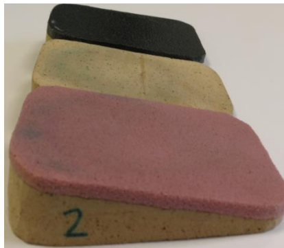
Figure.6.5 Talonnettes avec trois (03) matériaux différents
