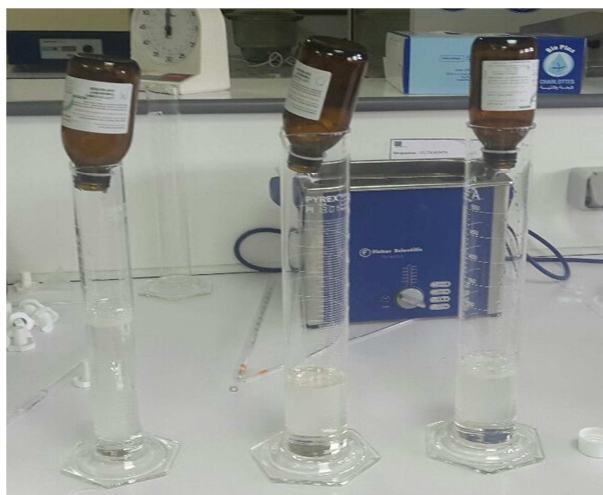
Figure 25: mesure de volume des trois échantillons.
