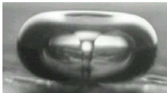
Bulle de cavitation implosant au voisinage d'une surface
