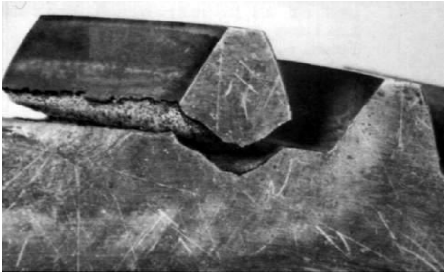
Figure III-5 : Dent cassée due aux fissures en pied de dent résultant de la fatigue liée aux charges cycliques de flexion
