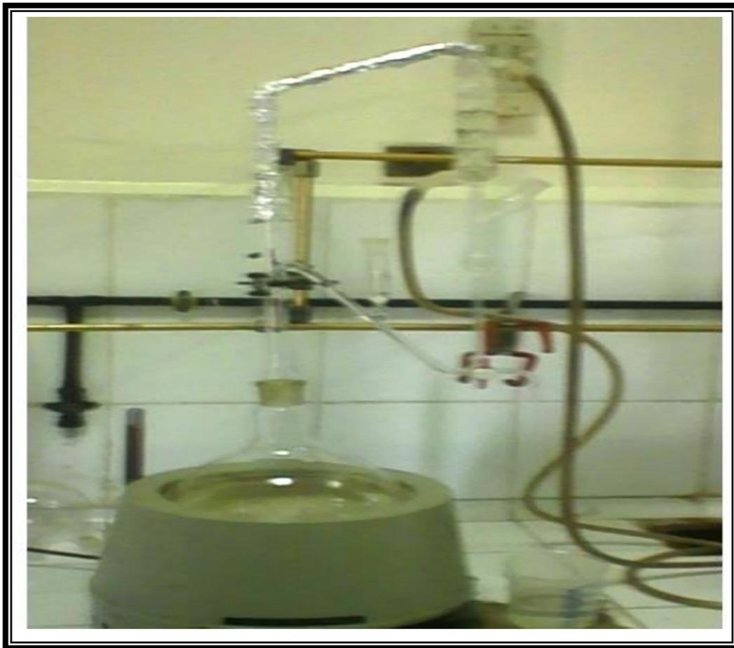
**Fig.7: Dispositif de l'hydrodistillation à l'échelle du laboratoire - Appareil Clevenger- (SAIDAL, 2016).**
