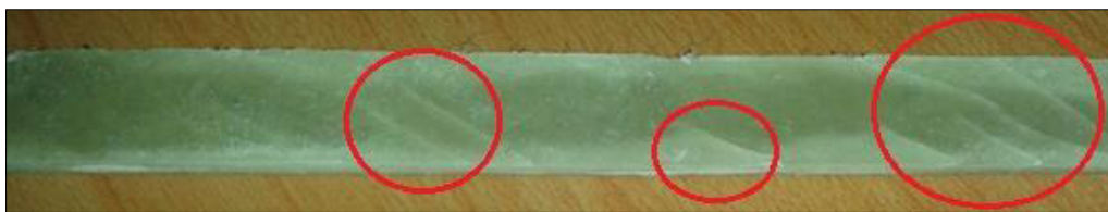
Figure II.3 : Epreuve de composite à des fissures visuelles à l'œil nues.
