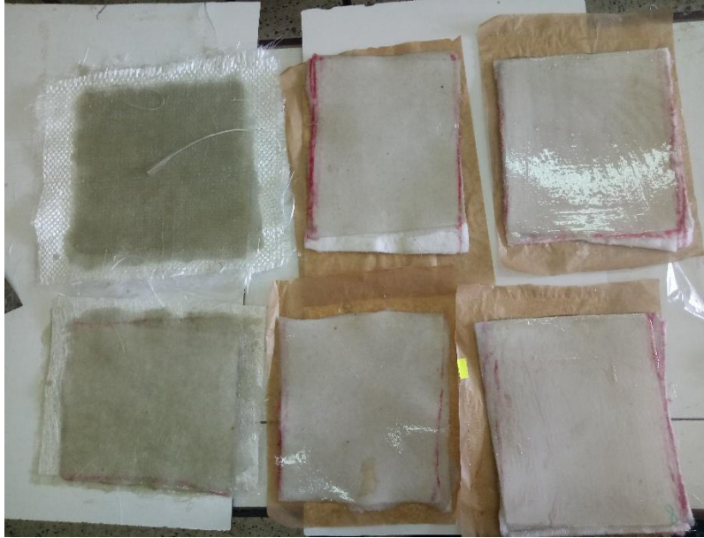
Figure II 1 : Les différents types des mats préparés par fibre de PET recyclé de masse surfacique.
