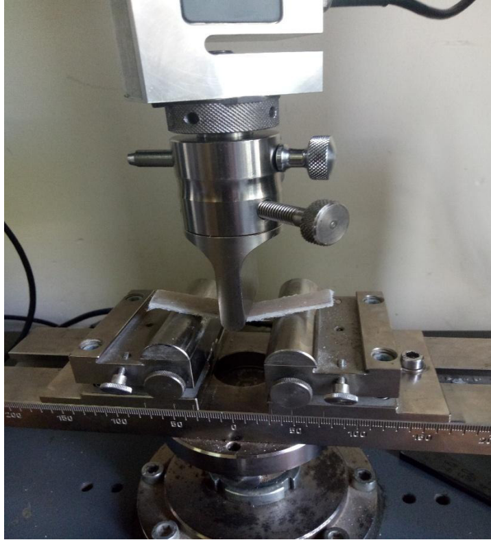
Figure II.4 : Schéma d'essai de flexion par la machine Zwick/Roell Z050.
