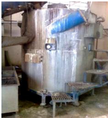
Figure 1.8 : Cuve de lavage.
