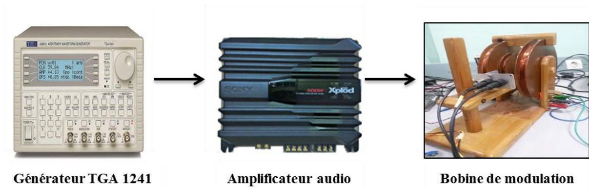
Figure III.16 : Modulation du champ magnétique
