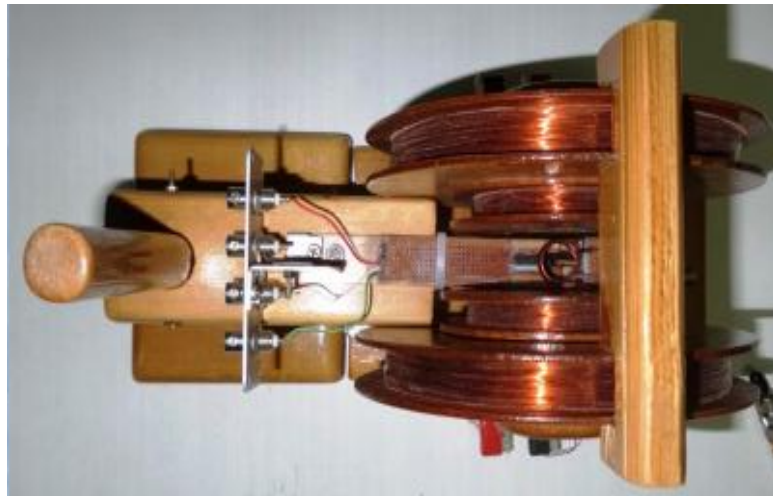
Figure III.13 : Bobine d' Helmholtz réalisée
