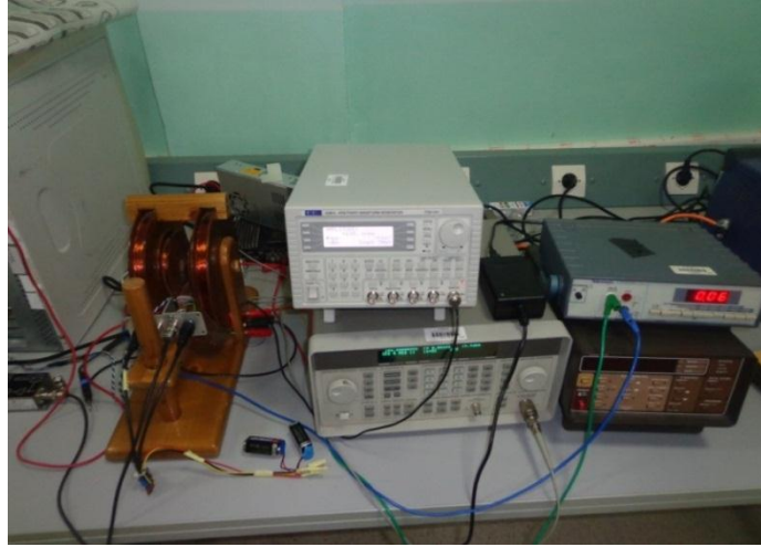
Figure III.11 : Spectromètre EDMR réalisé
