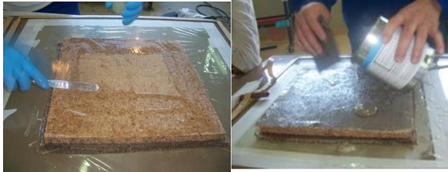
Figure 5.14 : Dépôt de la résine sur le liège et sur le tissu de jute.
