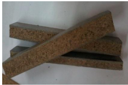
Figure 5.18 : Échantillons de sandwichs découpés suivant la norme AFNOR NF T 54-606.
