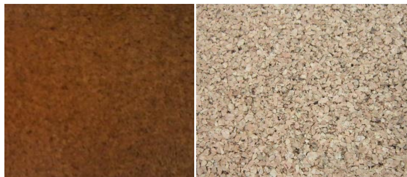
Figure..5.25 : Liège aggloméré avec et sans film de résine époxy.
