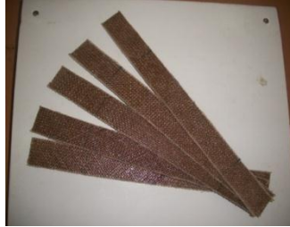
Figure 4.4. : Échantillons en composite stratifié (jute/polyester et jute /époxy).
