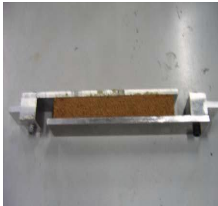
Figure 5.21 : Plaque de liège fixée sur deux supports métalliques indéformables.
