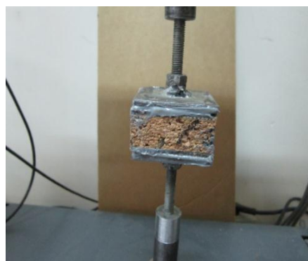
Figure 5.37 : Éprouvette placée pour l'essai de traction selon la norme (NF T 54-603).
