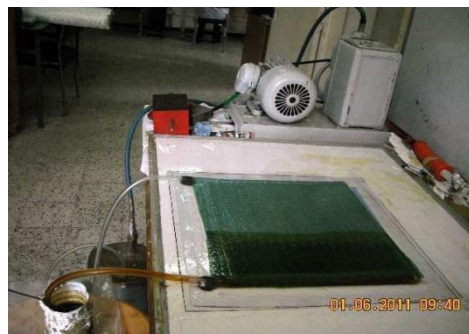
Figure 4.5. Elaboration sous vide, d'une plaque stratifiée.
