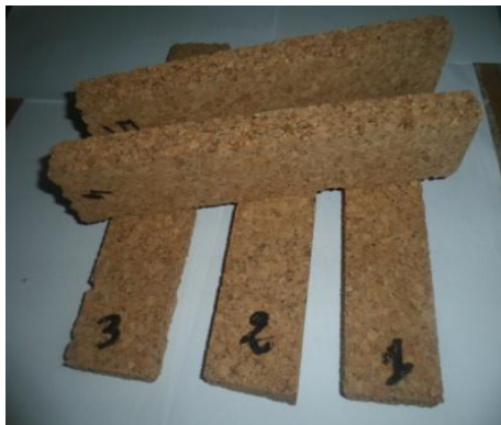
Figure 3.37. : Géométrie des éprouvettes de traction de liège.
