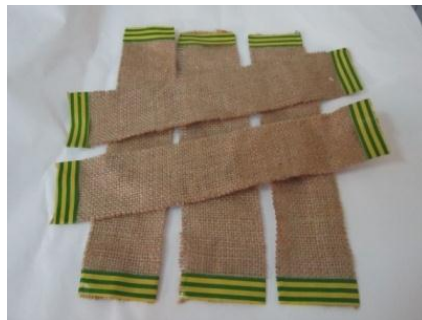
Figure 3.4. : Epreuves de traction de renfort en jute tissé.
