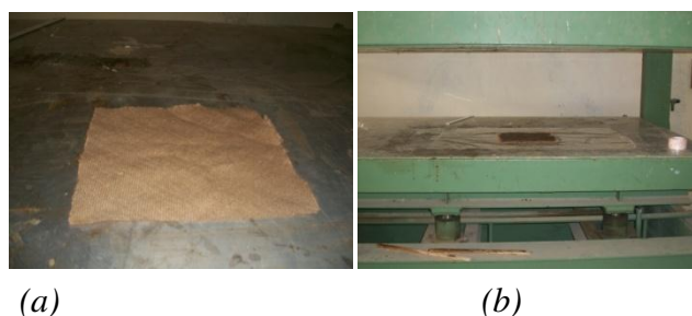
Fig. 4.3. (a) Tissu de jute, (b) plaque préparée pour le pressage
