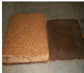
Figure 5.23 : décollement de la peau de sandwich à base de résine polyester.
