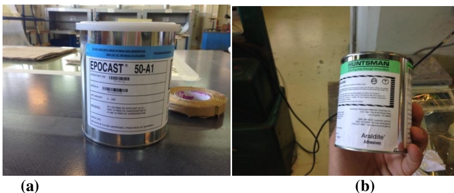
Figure 3.25. : (a)résine EPOCAST 50-A1, (b)durcisseur (HARDENER 9816)
