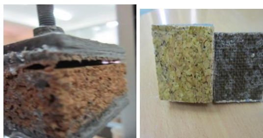
Figure 5.38 : décolllement de la peau de panneau sandwich.
