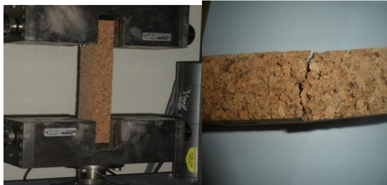
Figure 3.38 : Échantillons de lièges agglomérés instrumentés pour essais de traction.
