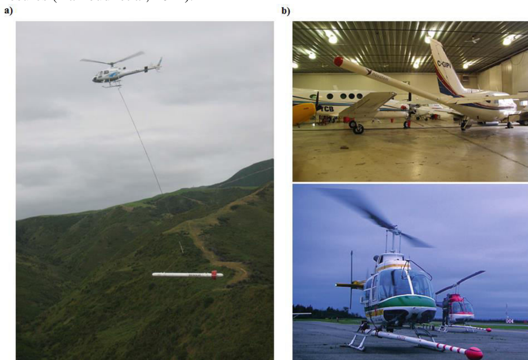
Figure 1.4 : Configuration du système de mesure magnétométrique. (a) Configuration en remorque oiseau (USGS), (b) Configuration en queue (Novatem)
